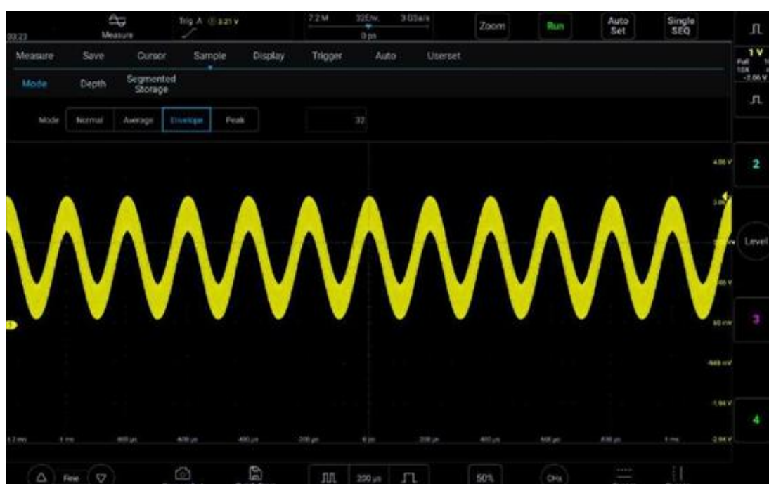
Рисунок 10-8. Сигнал амплитудной модуляции в режиме выборки «Огибающая» (32)
