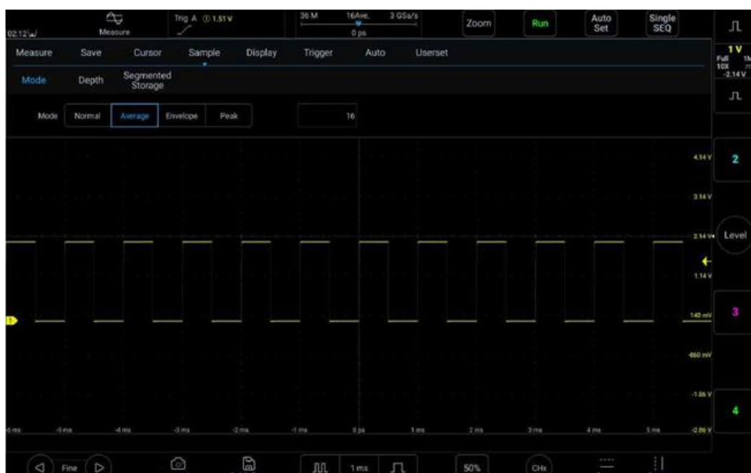
Рисунок 10-5. Осциллограмма после выбора режима выборки «Усреднение» с числом усреднений 16
