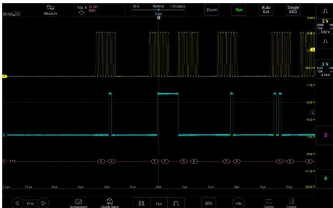
Рисунок 12-20. Интерфейс декодирования шины SPI
