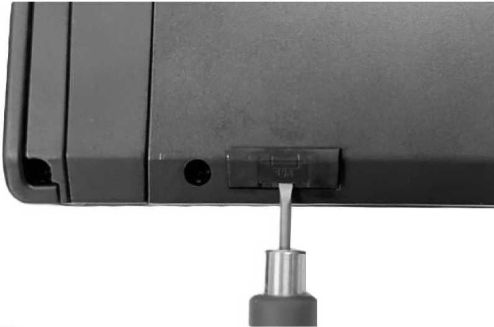
Рисунок 7-37. Снятие защитного колпачка предохранителя
