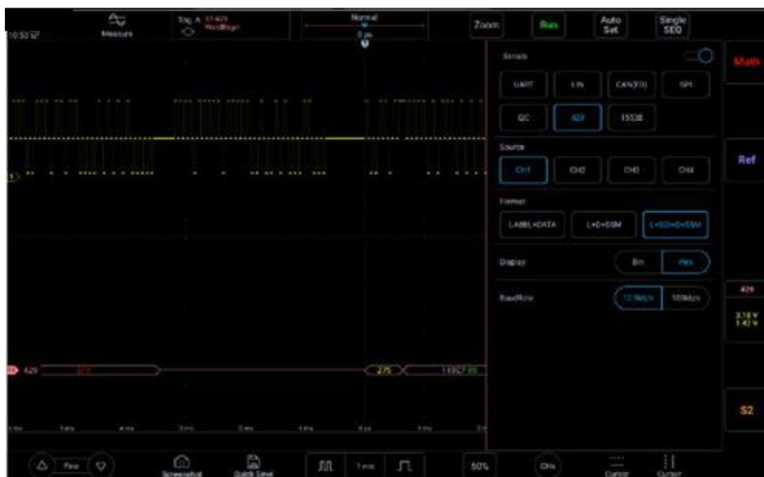
Рисунок 12-26. Меню конфигурации шины ARINC429
