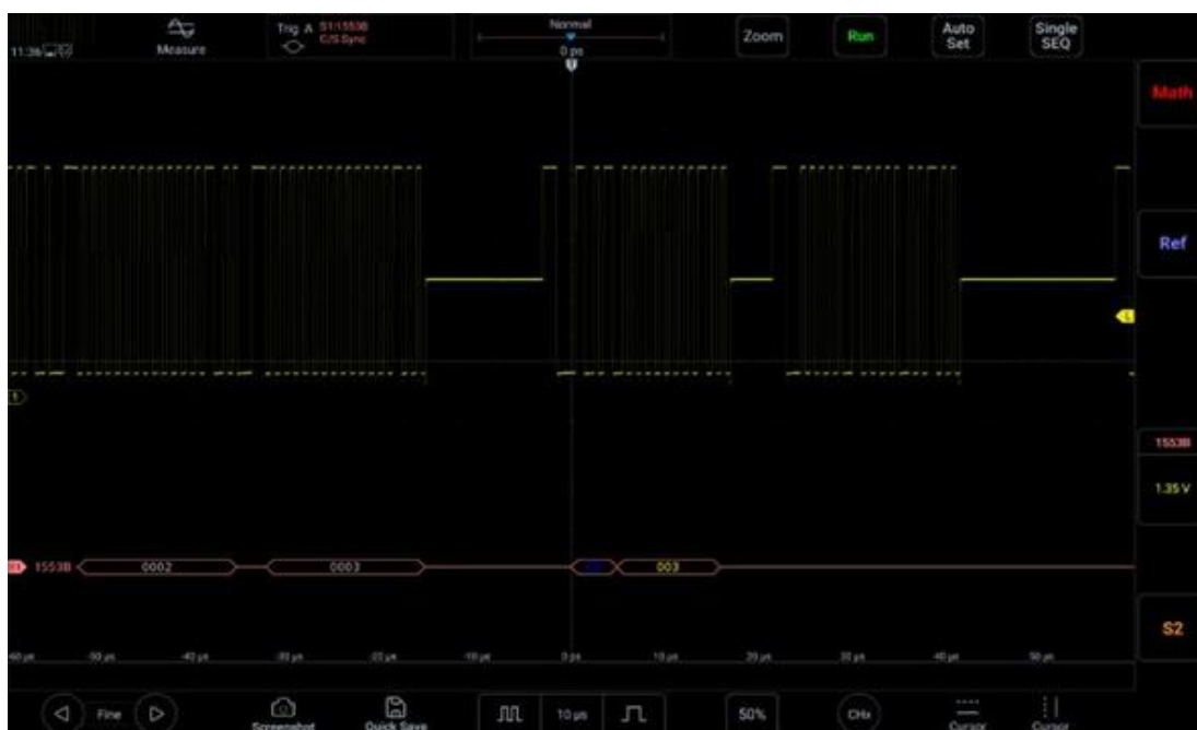
Рисунок 12-32. Графический интерфейс шины 1553B
