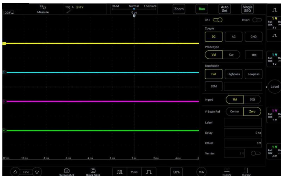
Рисунок 5-1. Интерфейс отображения меню канала
