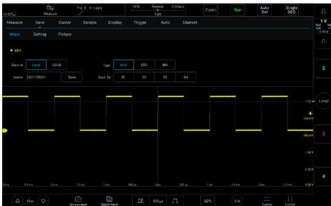
Рисунок 8-5. Сохранение интерфейса эталонной формы сигнала канала CH1
