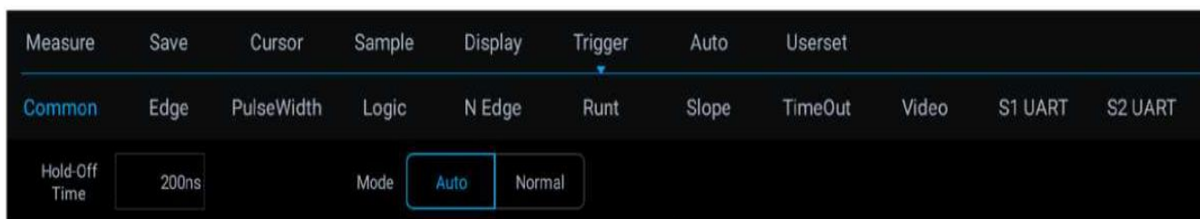
Рисунок 6-5. Настройка режима триггера осциллографа
