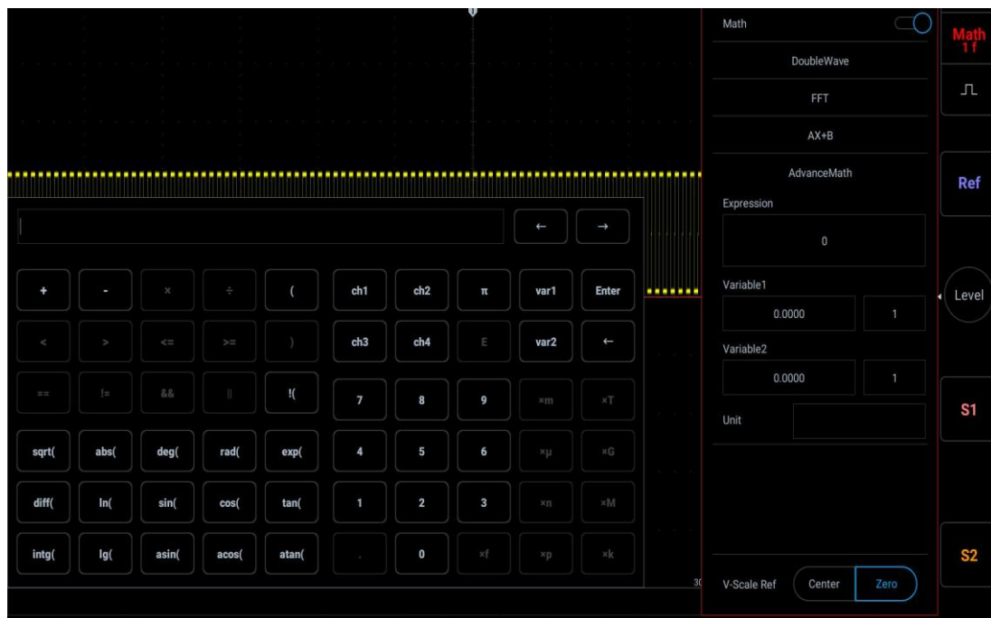
Рисунок 9-5. Расширенные математические функции
