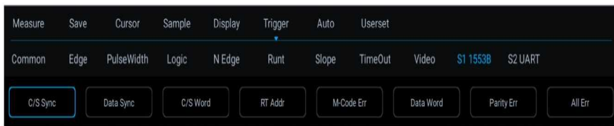
Рисунок 12-31. Меню конфигурации режима триггера шины 1553B
