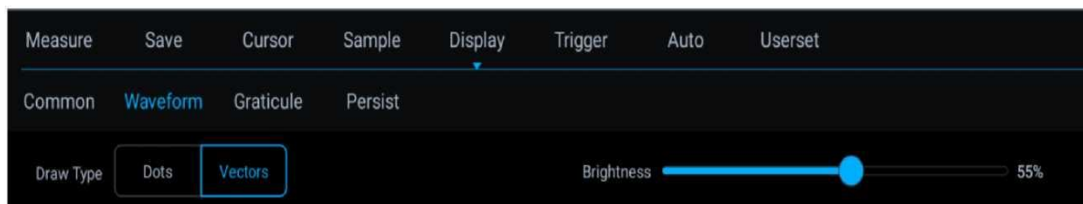
Рисунок 10-2. Меню отображения осциллограммы
