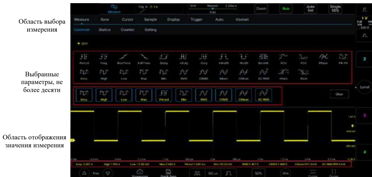
Рисунок 7-1. Меню автоматического измерения
