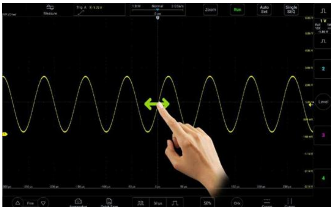
Рисунок 4-1. Перемещение формы сигнала по горизонтали на экране
