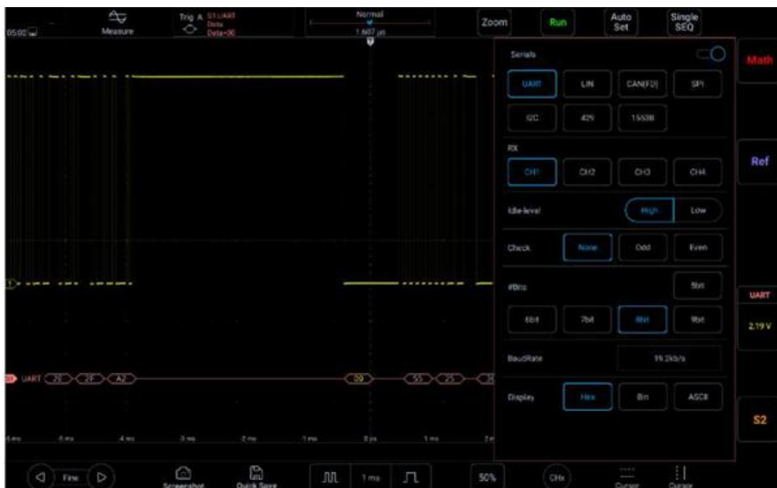
Рисунок 12-4. Меню конфигурации шины UART
