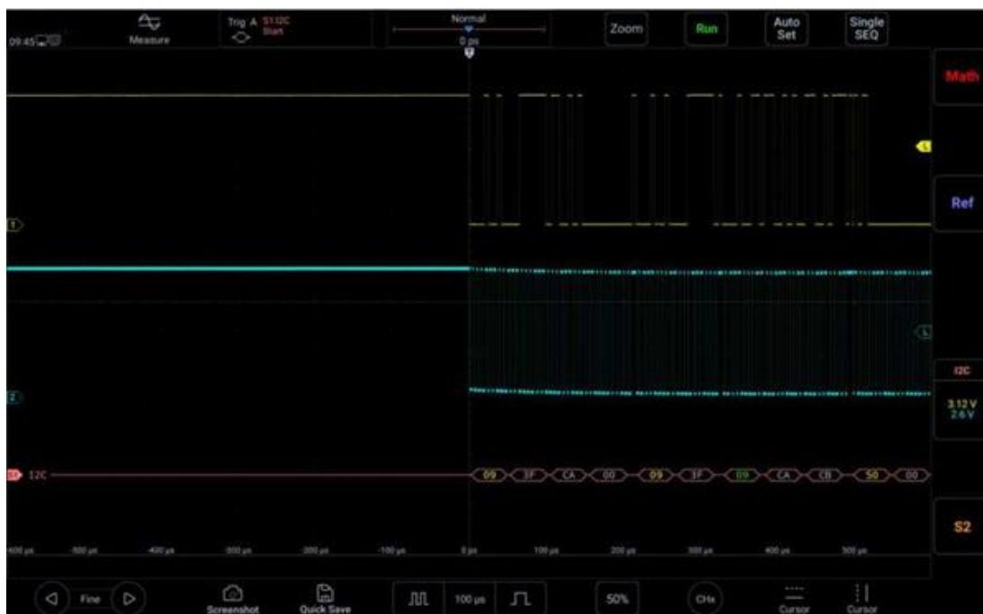
Рисунок 12-24. Графический интерфейс шины I 2 C
