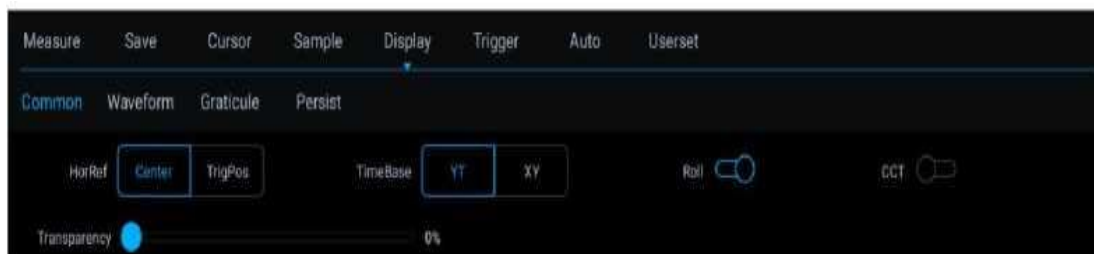
Рисунок 4-6. Включение/выключение режима «Roll»
