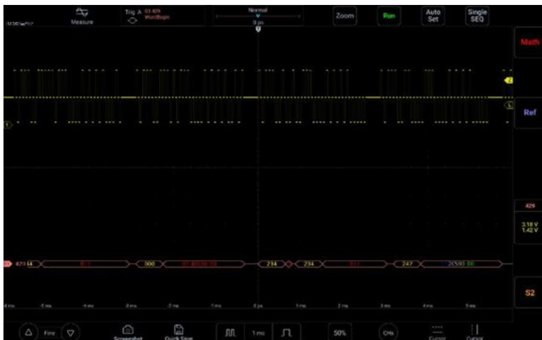
Рисунок 12-28. Графический интерфейс ARINC429
