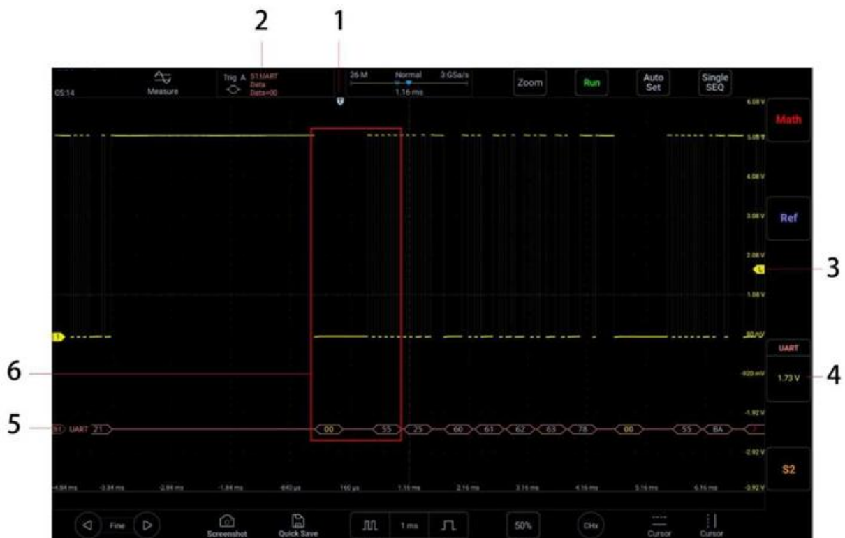
Рисунок 12-8. Графический интерфейс шины UART
