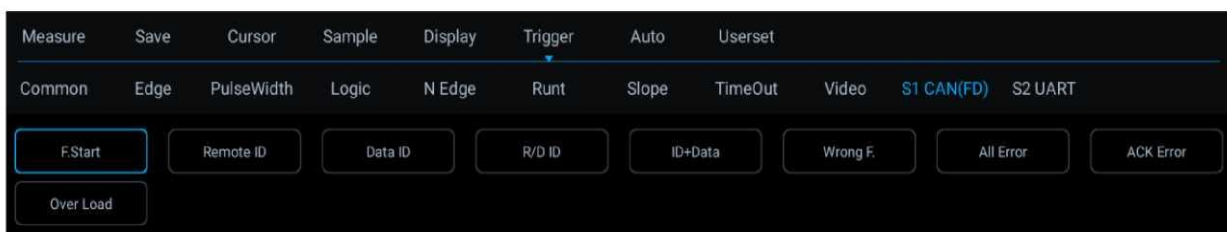
Рисунок 12-15. Меню конфигурации режима триггера шины CAN FD
