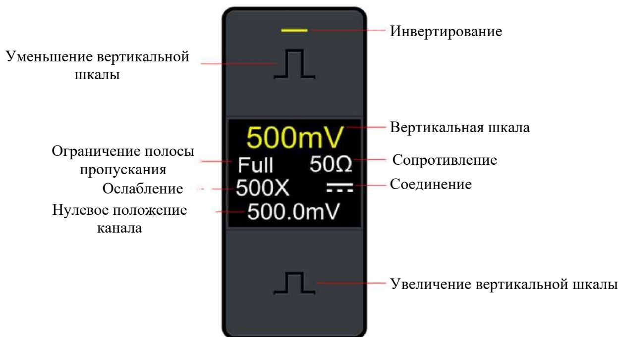
Рисунок 5-3. Интерфейс отображения канала
