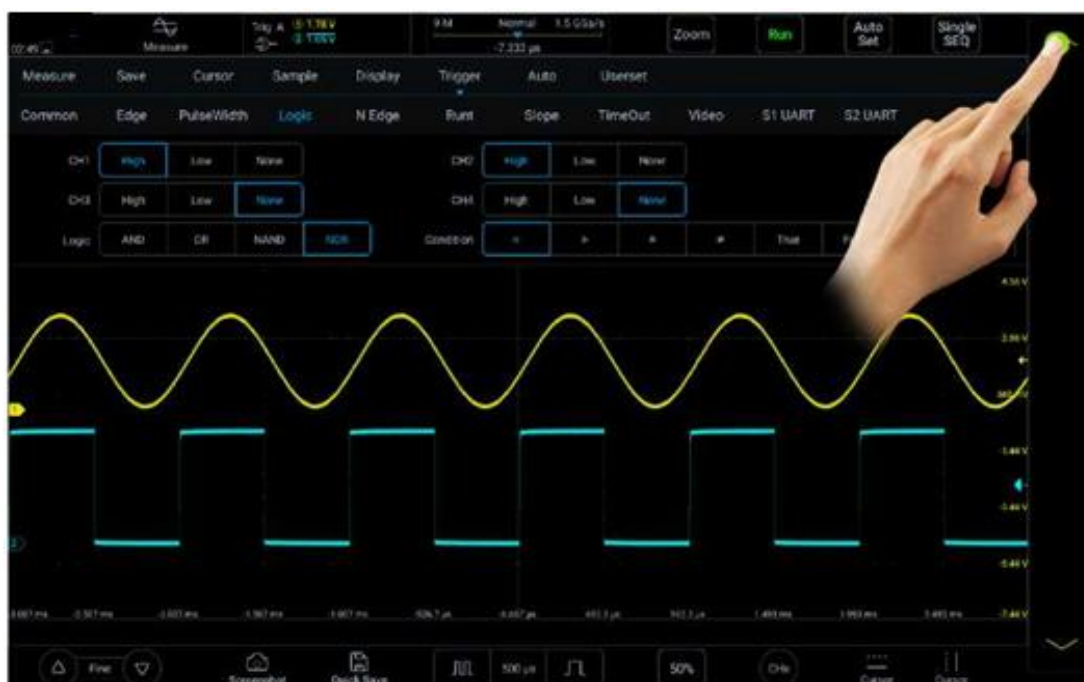
Рисунок 6-22. Регулировка уровня триггера
