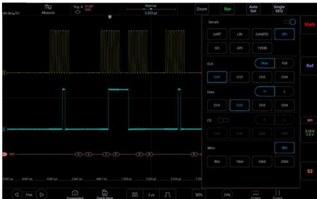
Рисунок 12-18. Меню конфигурации шины SPI
