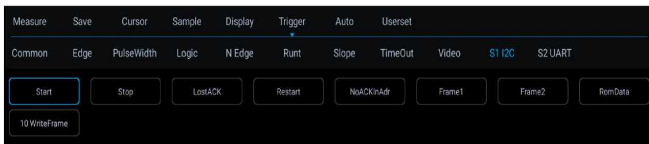
Рисунок 12-23. Меню конфигурации режима триггера шины I 2 C
