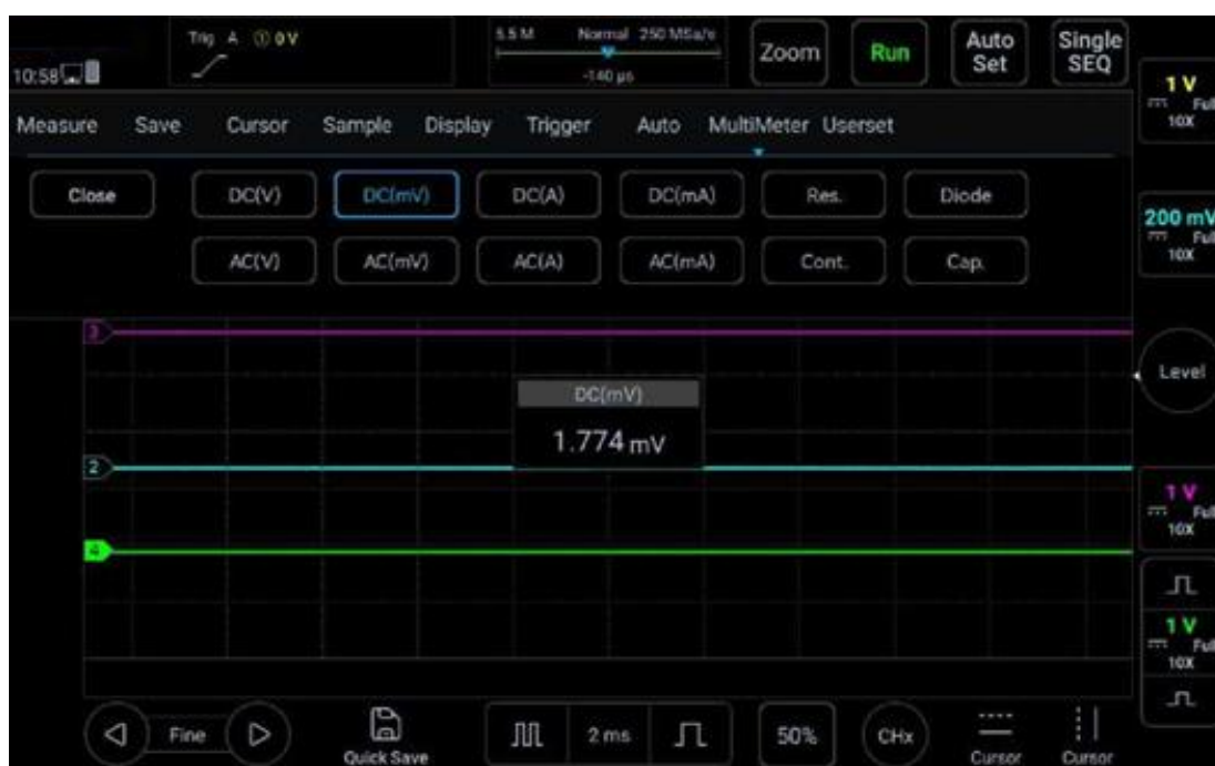
Рисунок 7-20. Блок отображения данных мультиметра
