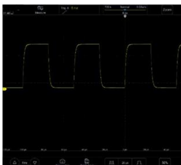
Рисунок 5-13. Фильтр нижних частот
