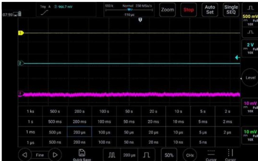
Рисунок 4-3. Ручка строчной развертки
