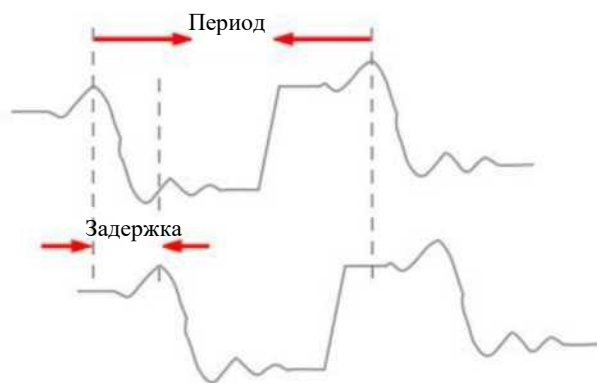
Рисунок 7-6. Схема измерения фазы
