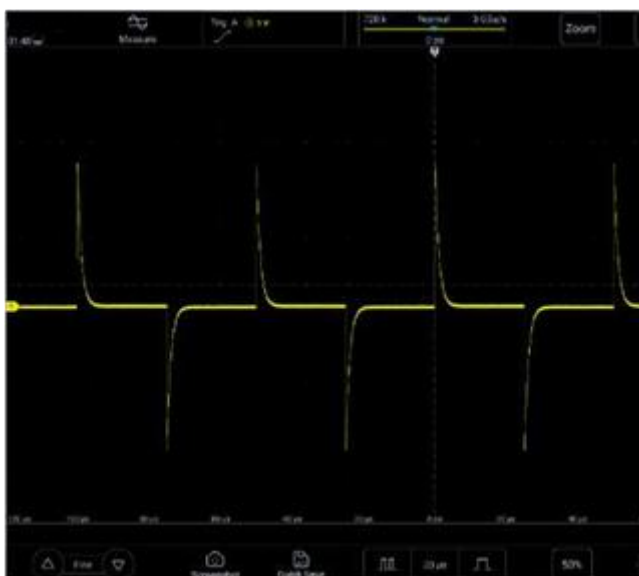
Рисунок 5-12. Фильтр верхних частот
