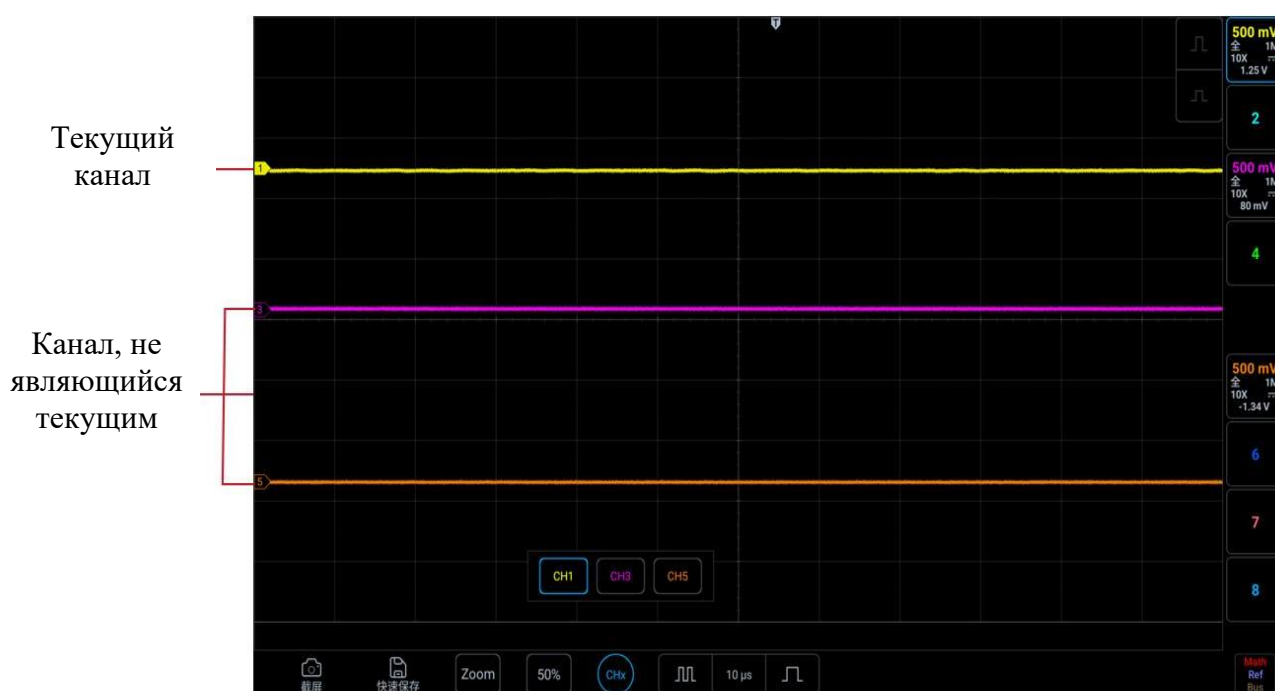
Рисунок 5-2. Текущий канал и канал, не являющийся текущим
