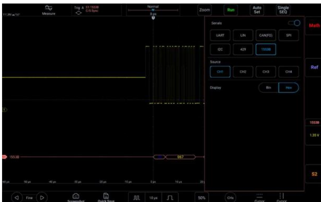
Рисунок 12-30. Меню конфигурации шины 1553B
