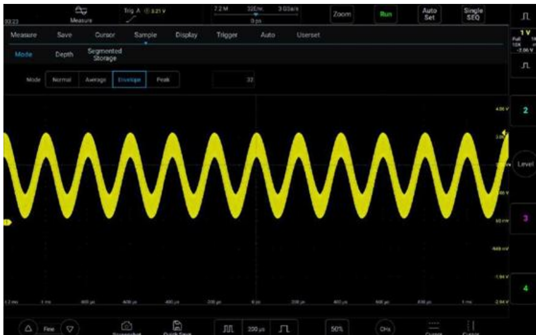
Рисунок 11-8. Сигнал амплитудной модуляции в режиме выборки «Огибающая» (32)
