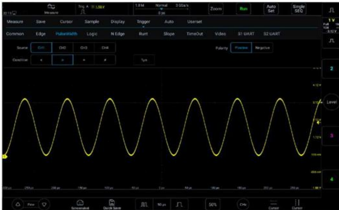
Рисунок 6-14. Меню настройки триггера по длительности импульса
