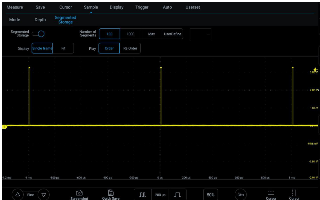
Рисунок 11-11. Получение осциллограмм из сегментированного хранилища
