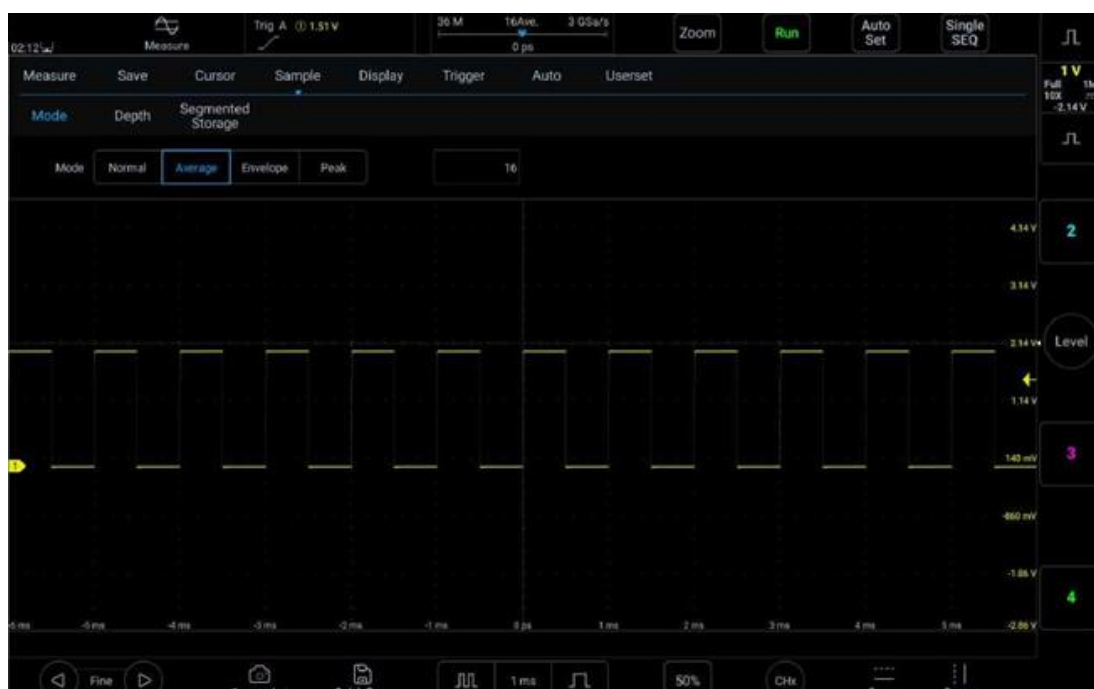
Рисунок 11-5. Осциллограмма после выбора режима выборки «Усреднение» с числом усреднений 16
