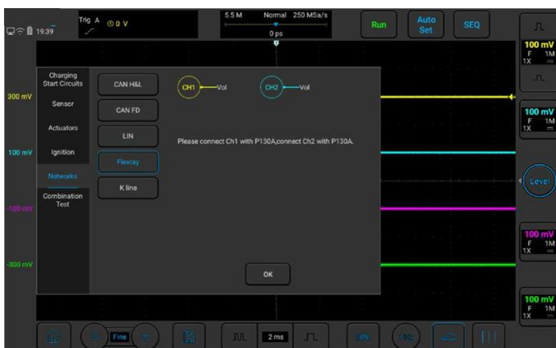
Рисунок 3-54. Проверка шины FlexRay
