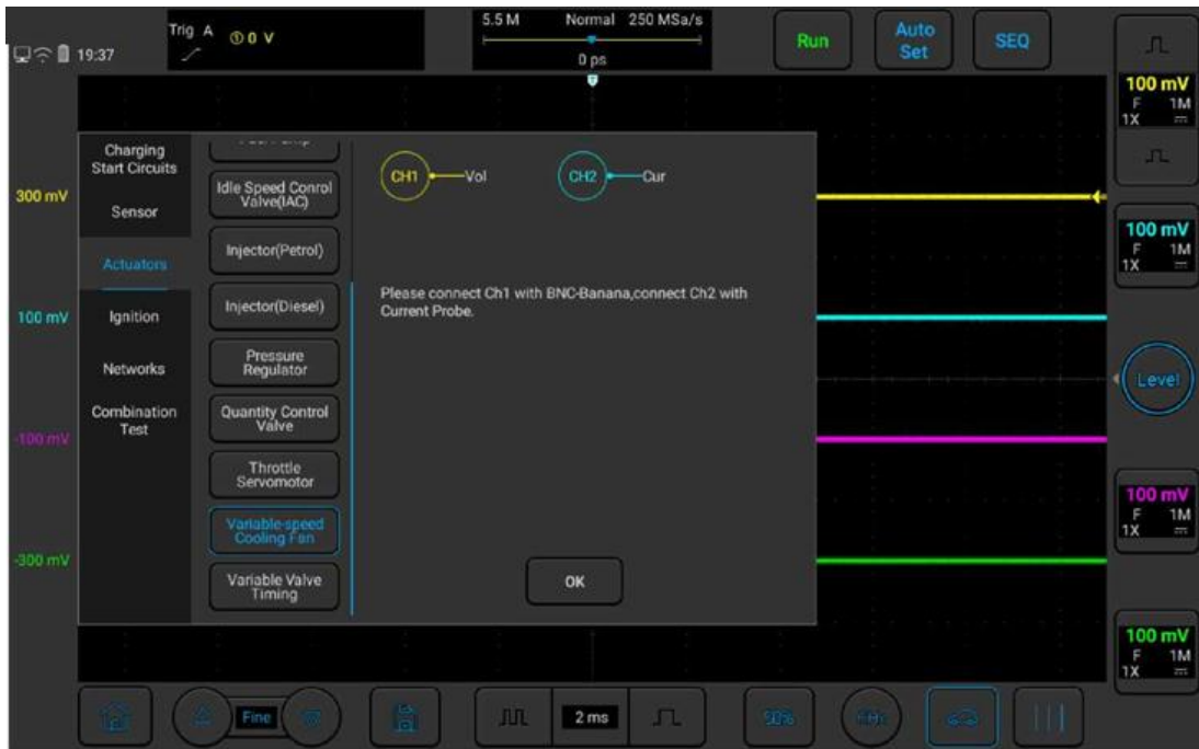
Рисунок 3-41. Проверка вентилятора охлаждения с переменной скоростью
