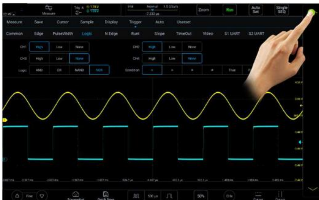
Рисунок 6-22. Регулировка уровня триггера
