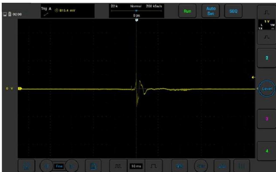
Рисунок 3-22. Фактическая схема измерений датчика детонации
