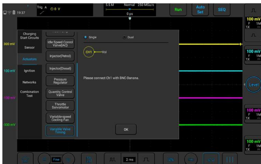
Рисунок 3-43. Проверка изменения фаз газораспределения
