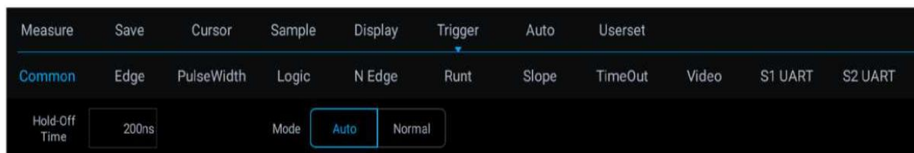
Рисунок 6-5. Настройка режима триггера осциллографа
