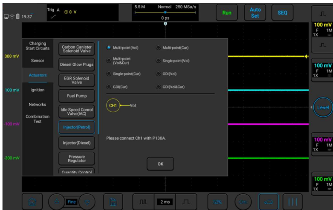
Рисунок 3-35. Проверка инжектора (бензин)
