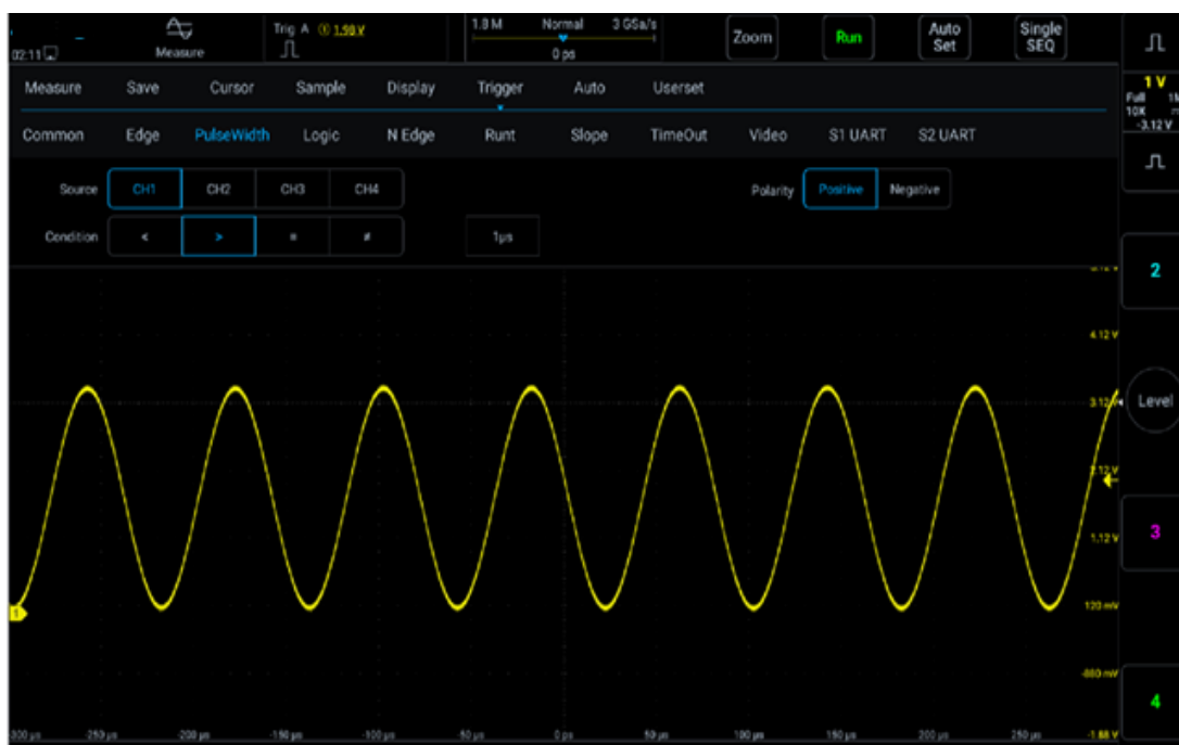
Рисунок 6-15. Изменение уровня импульса отрицательной полярности
