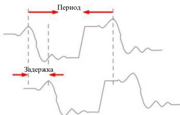
Рисунок 7-4. Схема измерения фазы
