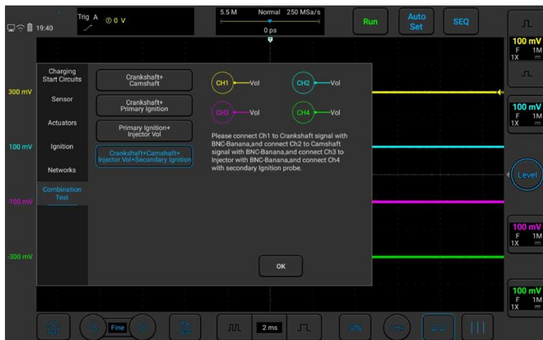
Рисунок 3-61. Комбинированное испытание коленчатого вала + распределительного вала + топливного инжектора + вторичной обмотки системы зажигания
