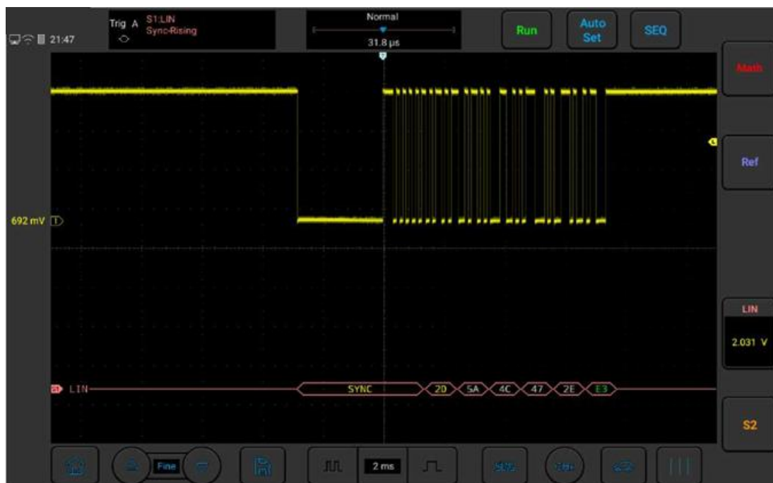
Рисунок 3-53. Измерение LIN-шины автомобиля Audi A6
