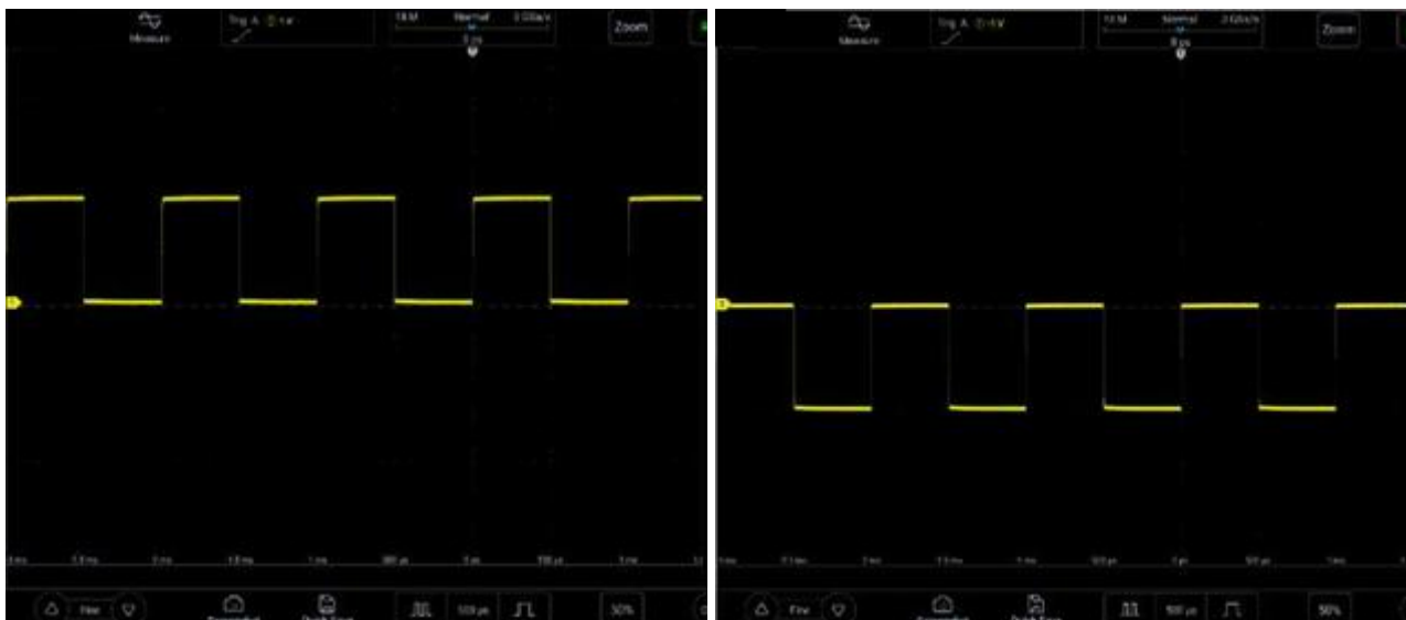
Рисунок 5-11. Перед инверсией с учетом формы импульса Рисунок 5-12. После инверсии с учетом формы импульса
