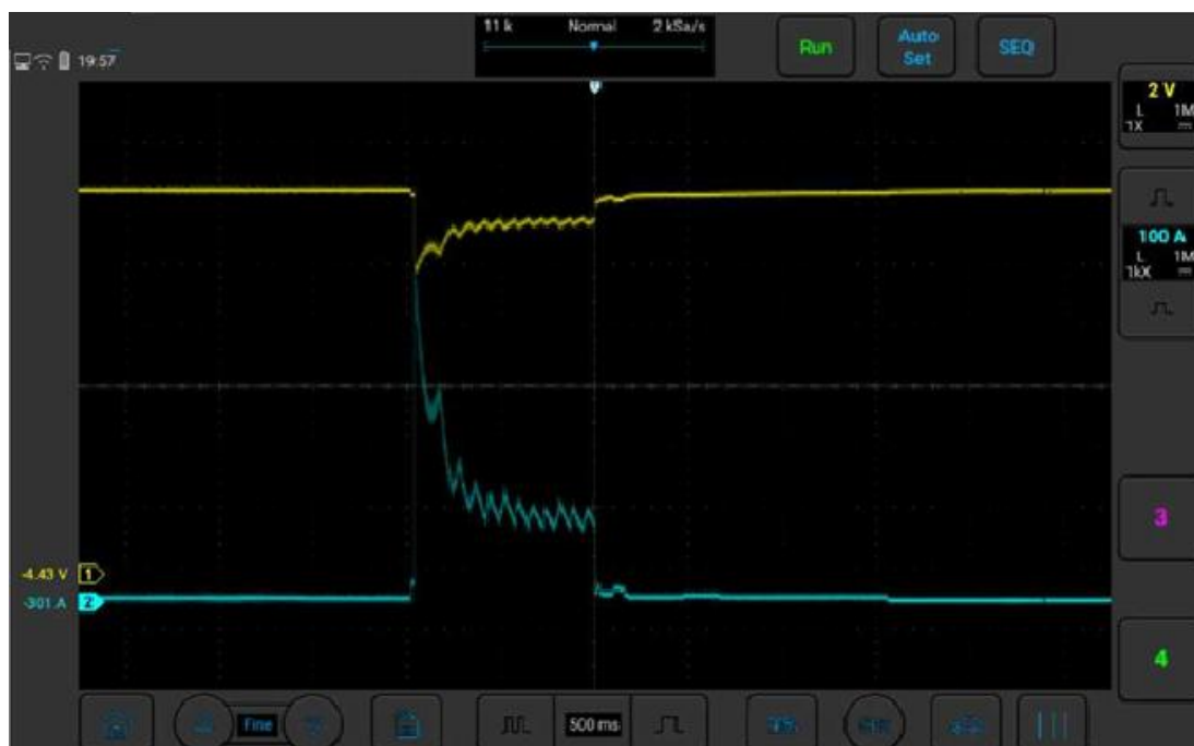
Рисунок 3-7. Пусковое напряжение и ток
