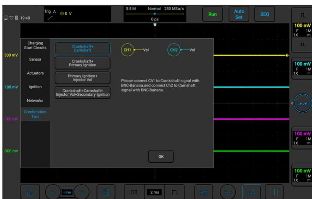
Рисунок 3-56. Комбинированное испытание коленчатого вала и распределительного вала
