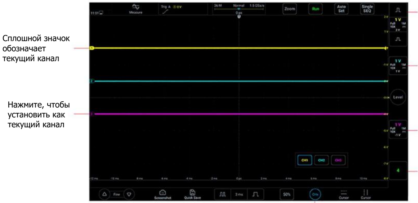
Рисунок 5-4. Открытие, закрытие и переключение каналов
