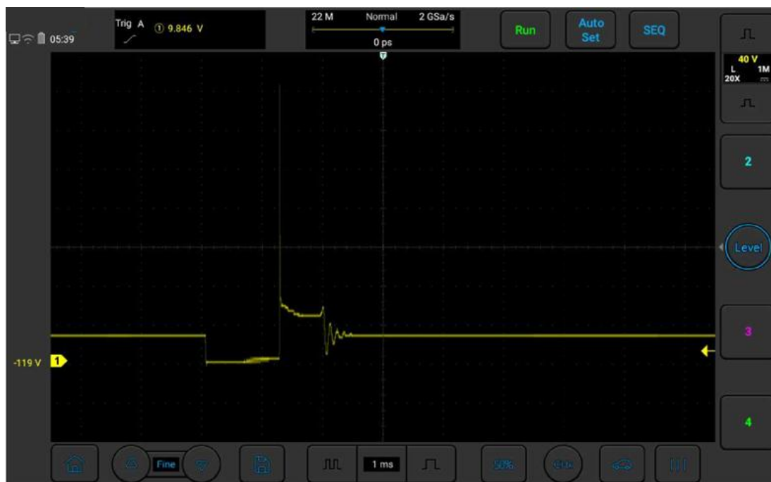
Рисунок 3-46. Фактическое испытание первичной обмотки системы зажигания
