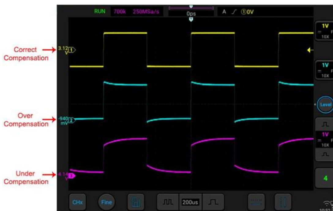
Рисунок 2-11. Компенсация пробника
