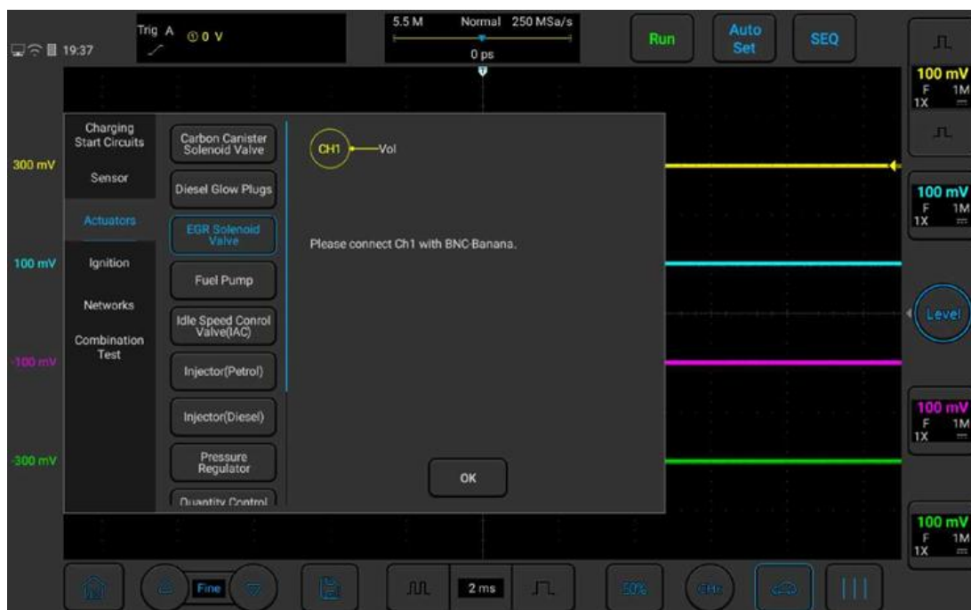
Рисунок 3-32. Проверка электромагнитного клапана рециркуляции отработавших газов
