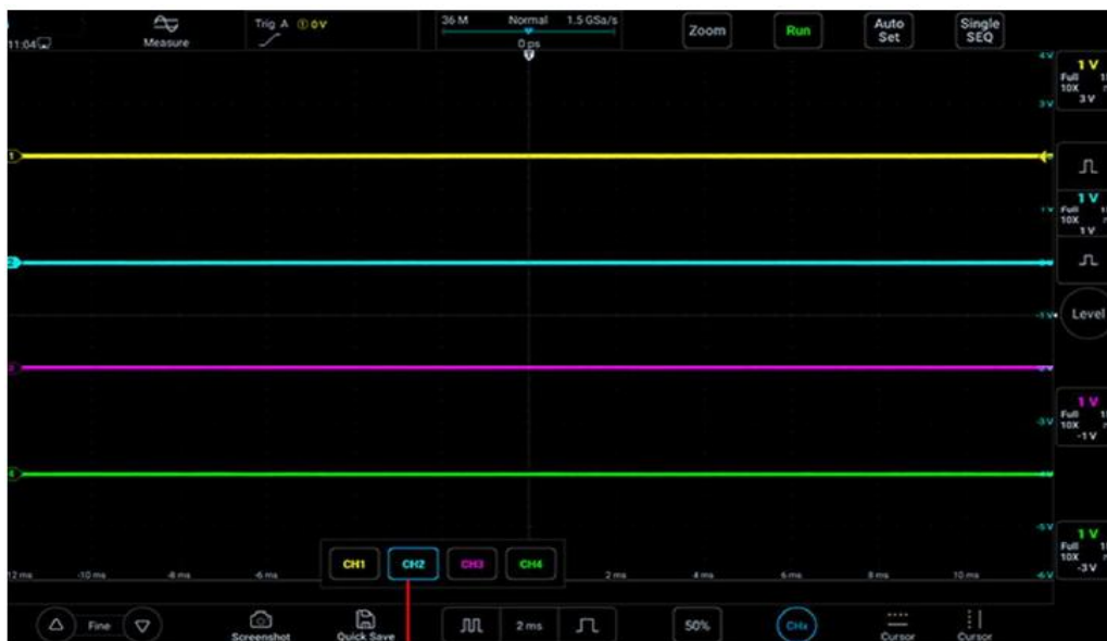
Рисунок 5-4. Открытие, закрытие и переключение каналов
