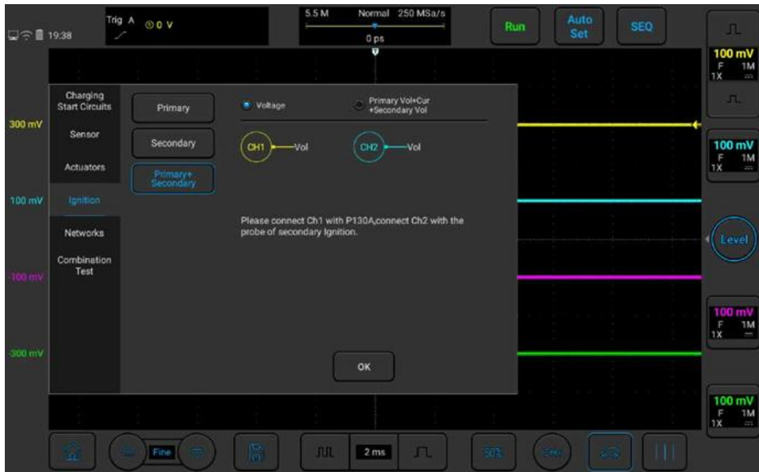
Рисунок 3-48. Испытание первичной + вторичной обмотки системы зажигания
