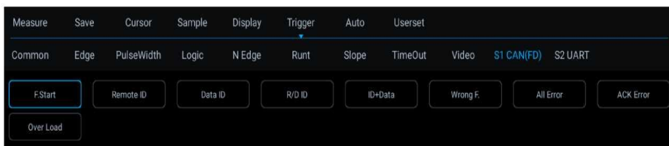
Рисунок 12-6. Меню конфигурации режима триггера шины CAN FD. Описание меню выбора режима триггера:
