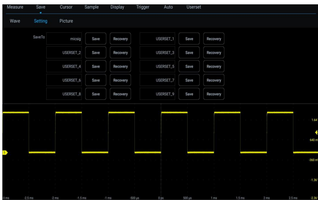
Рисунок 8-4. Сохранение настроек осциллографа
