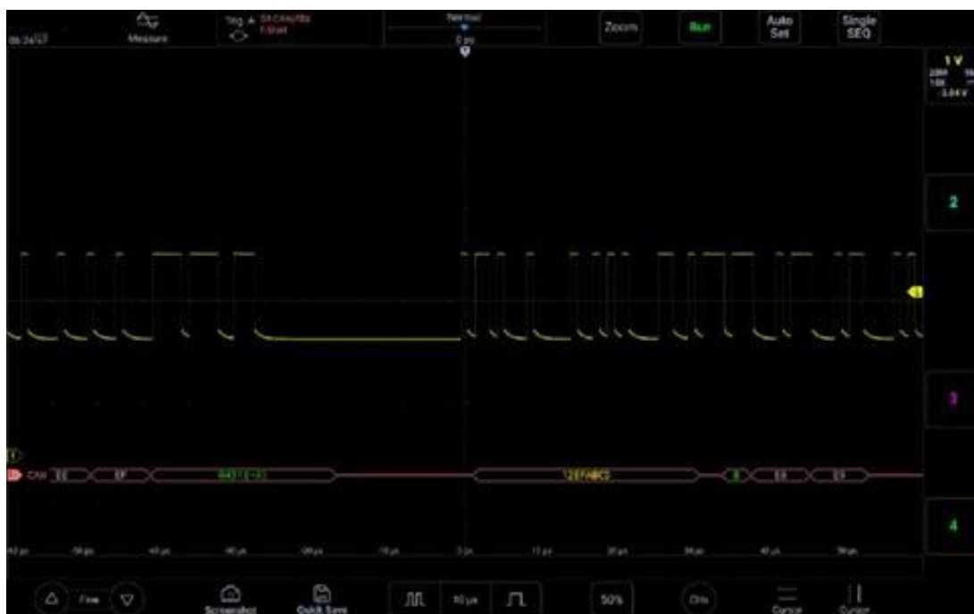
Рисунок 12-7. Интерфейс декодирования шины CAN
