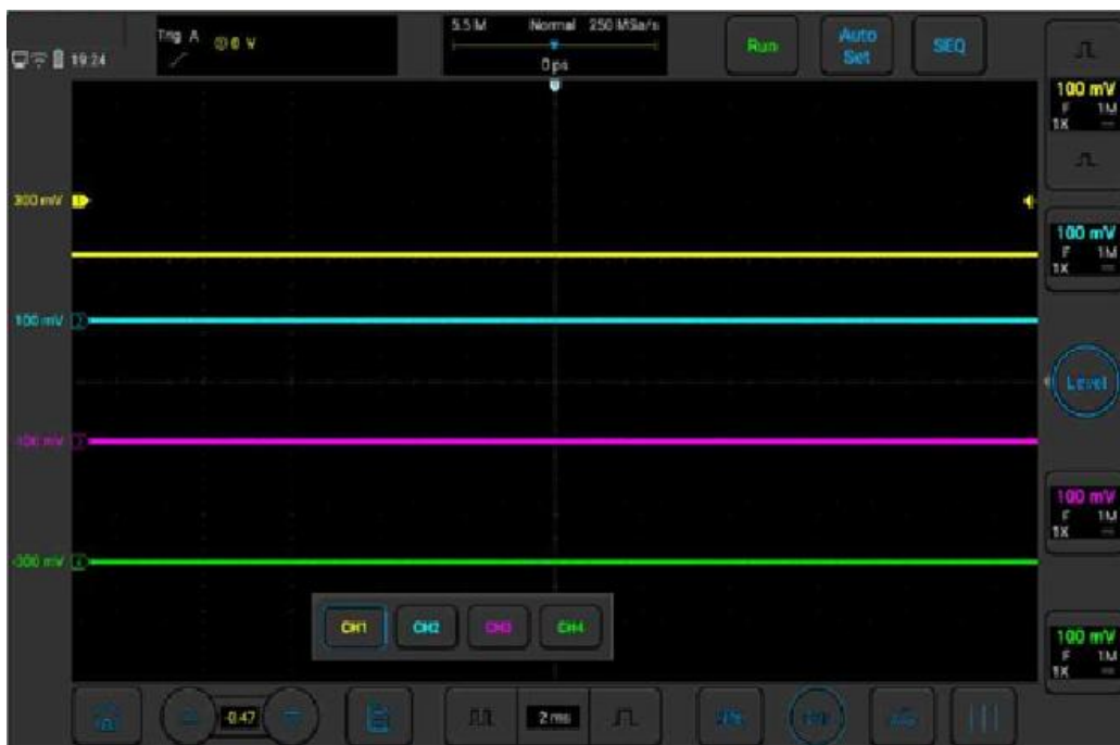
Рисунок 2-13. Ручная калибровка нулевого значения
