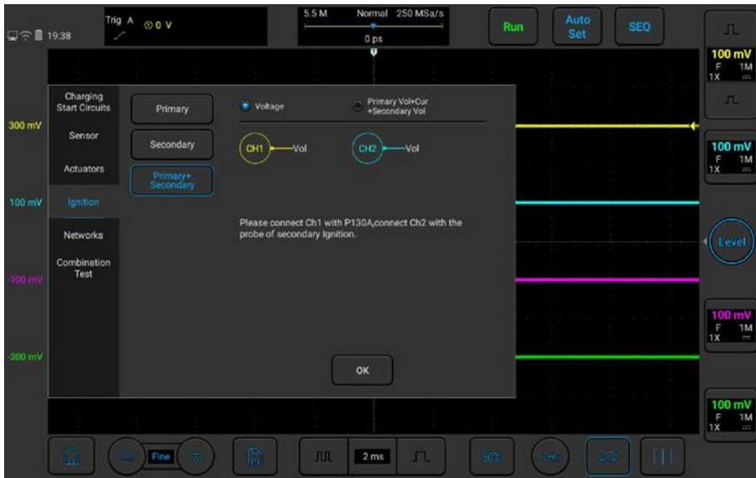
Рисунок 3-44. Испытание первичной + вторичной обмотки системы зажигания
