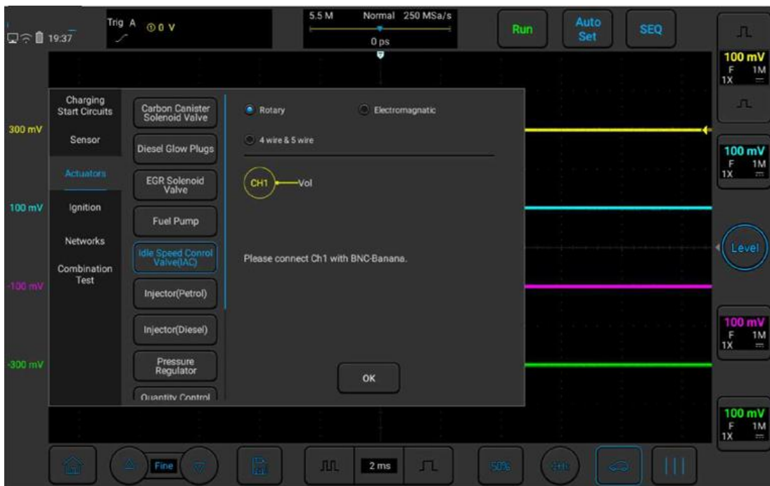
Рисунок 3-31. Проверка клапана регулировки холостого хода
