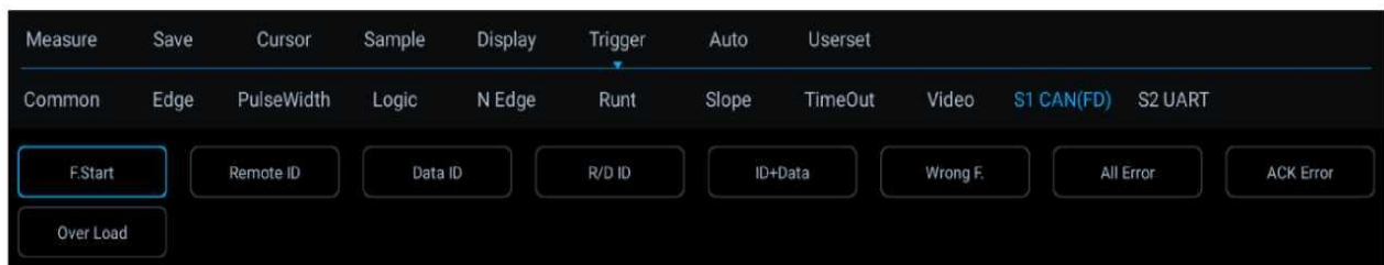
Рисунок 12-15. Меню конфигурации режима триггера шины CAN FD
