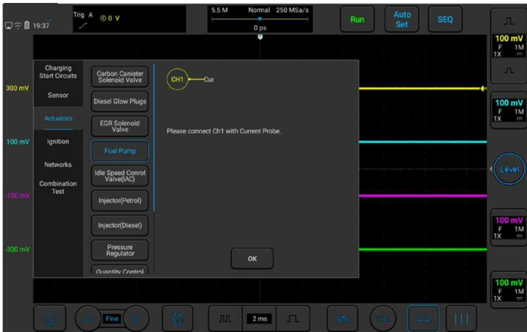
Рисунок 3-30. Проверка электронного топливного насоса
