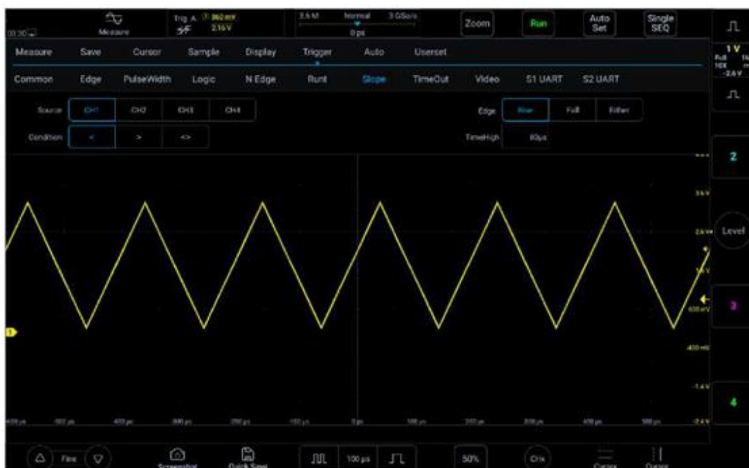
Рисунок 6-27. Меню настройки триггера по наклону
