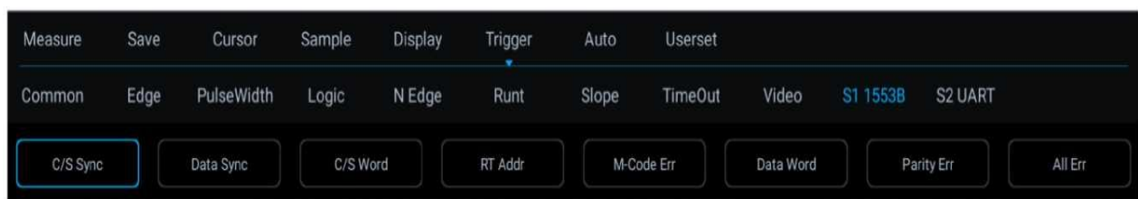
Рисунок 12-31. Меню конфигурации режима триггера шины 1553B
