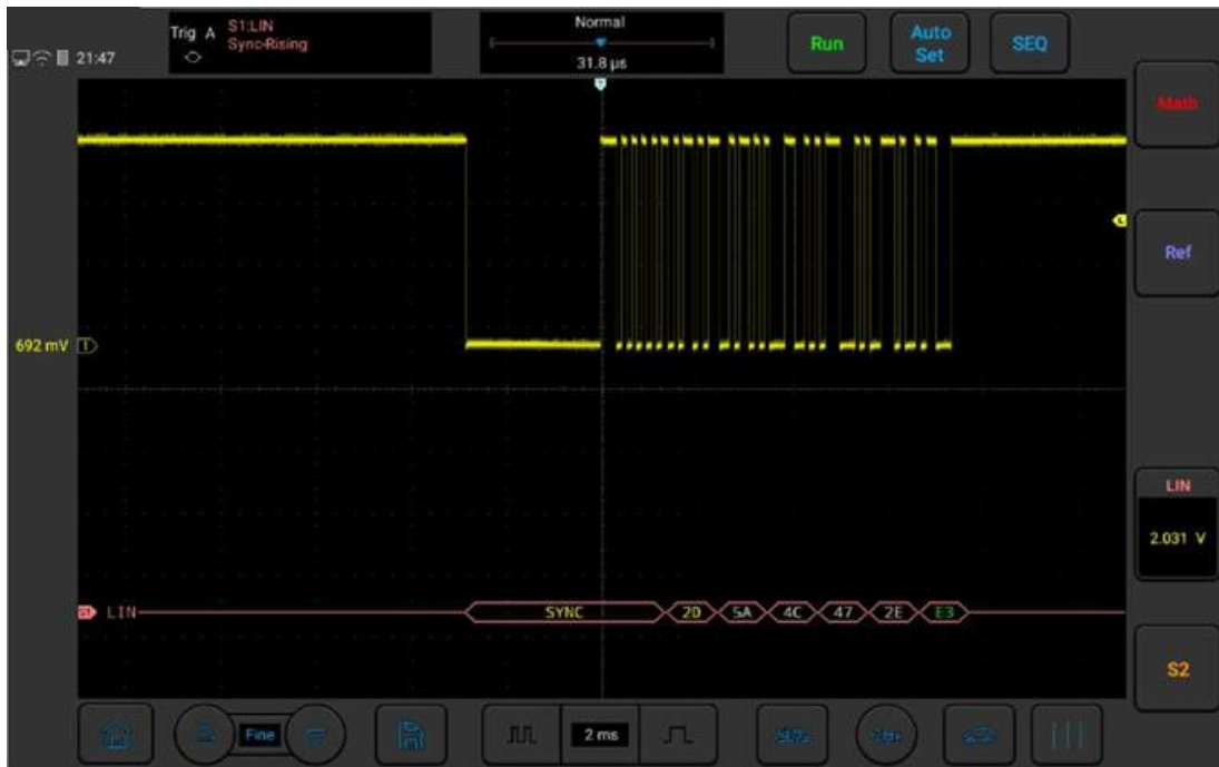
Рисунок 3-48. Измерение LIN-шины автомобиля Audi A6
