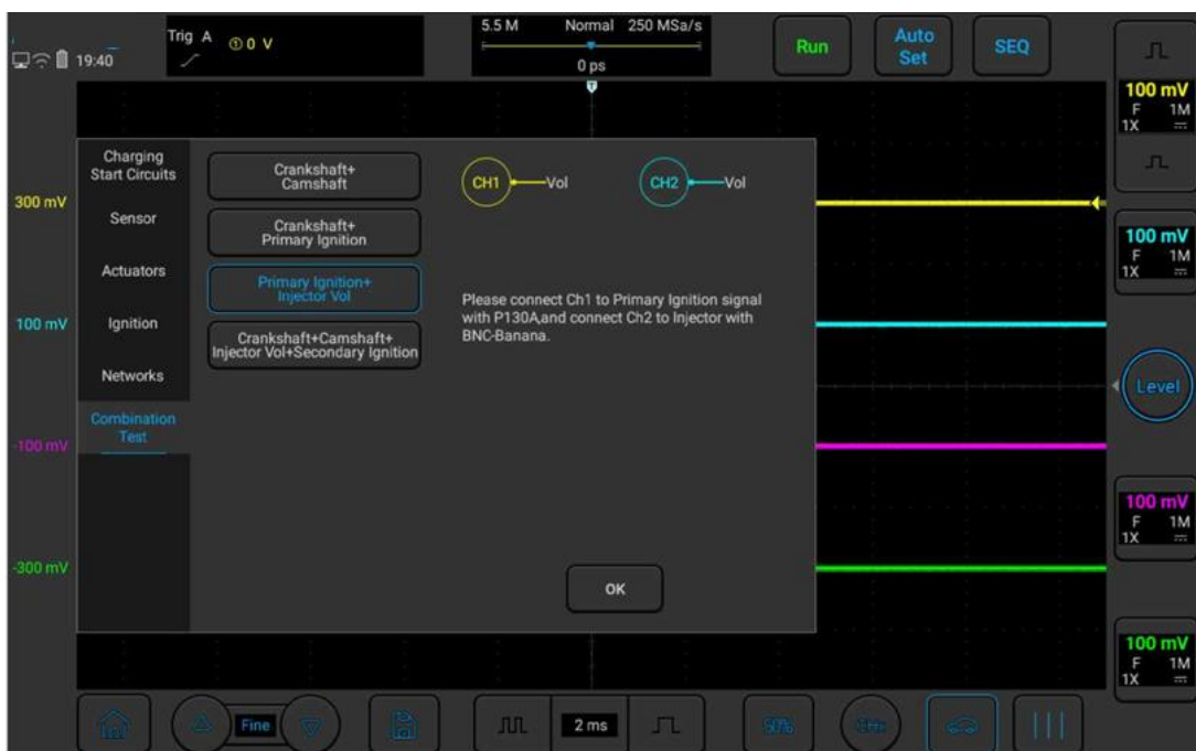
Рисунок 3-52. Первичная обмотка системы зажигания + напряжение инжектора
