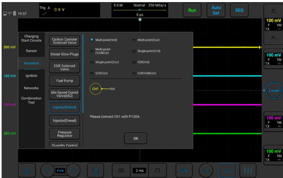
Рисунок 3-32. Проверка инжектора (бензин)
