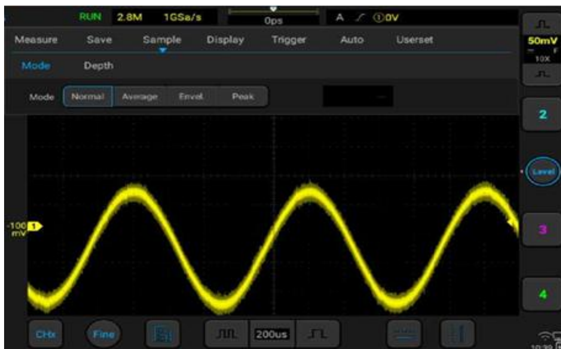
Рисунок 11-5. Синусоида с неровностями. Обычный режим выборки
