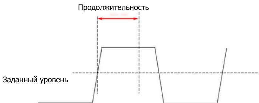
Рисунок 6-28. Схема триггера по лимиту времени
