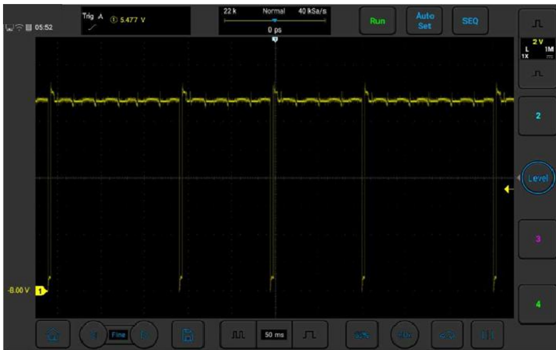
Рисунок 3-27. Сигнал электромагнитного клапана бачка с активированным углем Audi A6
