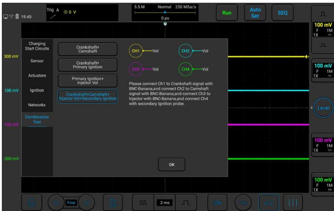
Рисунок 3-53. Комбинированное испытание коленчатого вала + распределительного вала + топливного инжектора + вторичной обмотки системы зажигания
