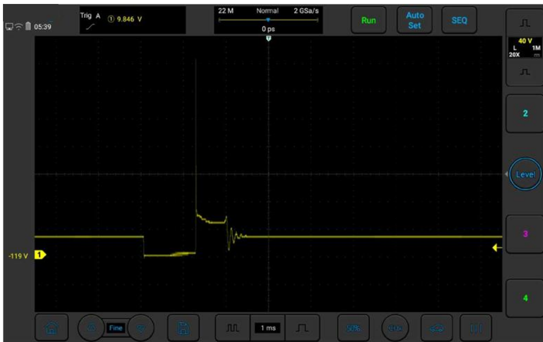
Рисунок 3-42. Фактическое испытание первичной обмотки системы зажигания
