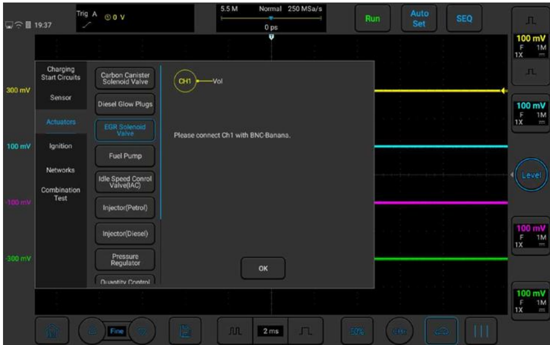
Рисунок 3-29. Проверка электромагнитного клапана рециркуляции отработавших газов
