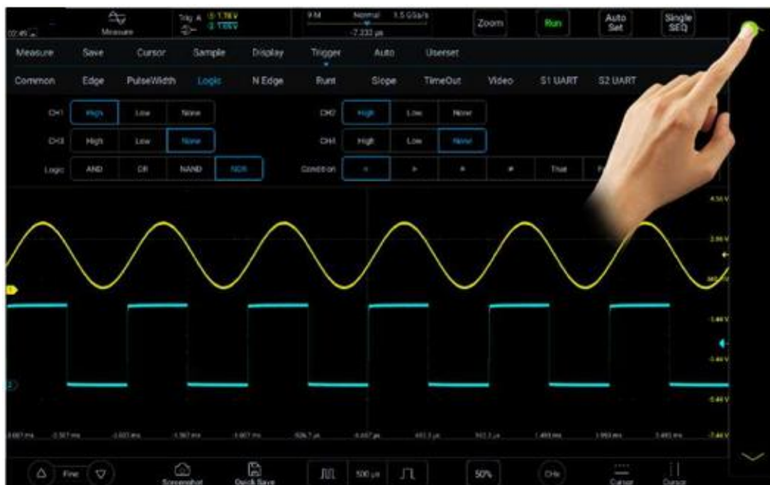
Рисунок 6-22. Регулировка уровня триггера
