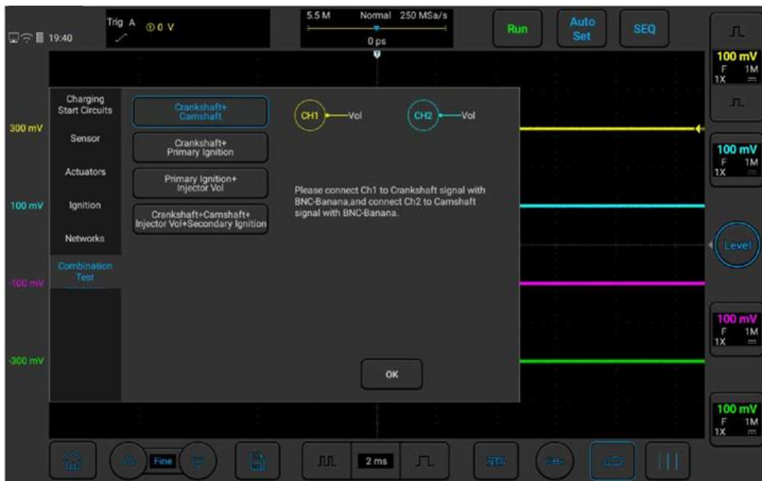
Рисунок 3-50. Комбинированное испытание коленчатого вала и распределительного вала
