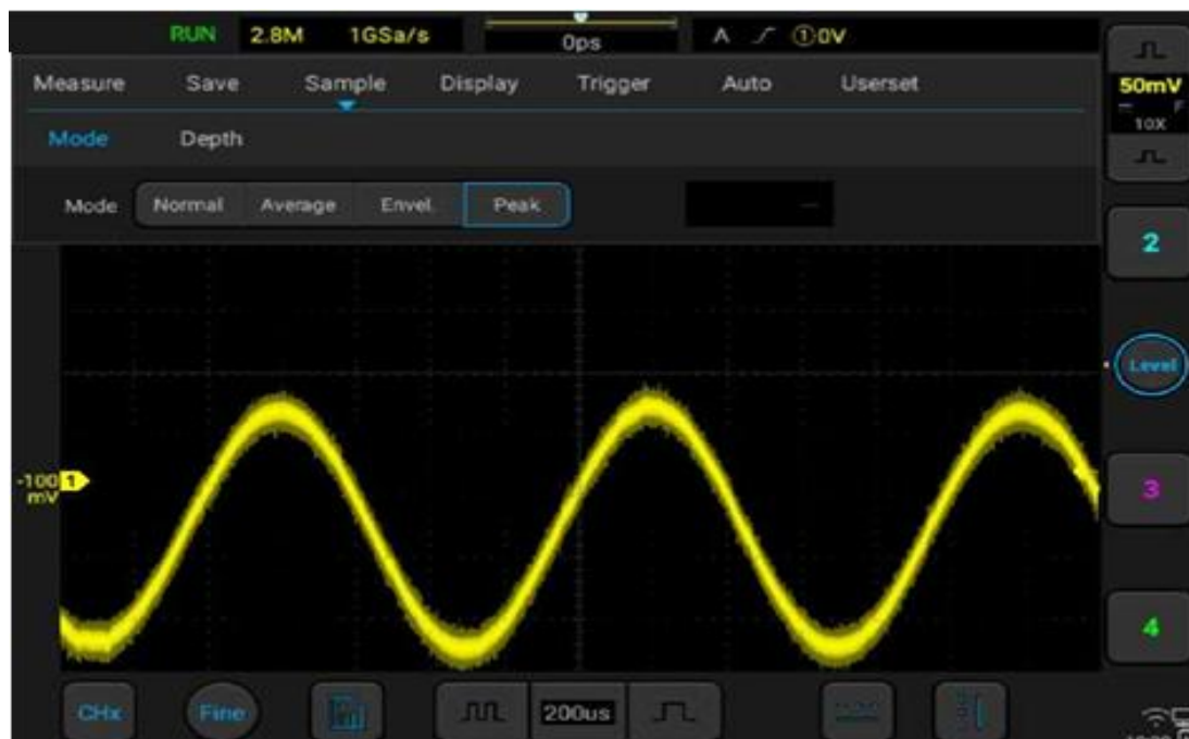
Рисунок 11-6. Синусоида с неровностями. Пиковый режим выборки
