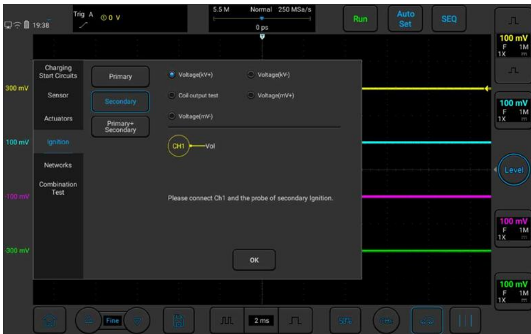
Рисунок 3-43. Испытание вторичной обмотки системы зажигания
