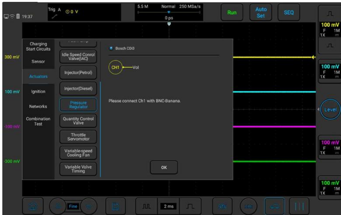
Рисунок 3-34. Проверка регулятора давления
