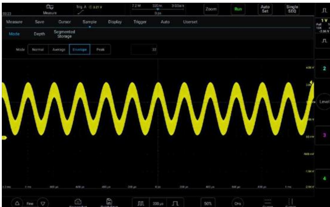
Рисунок 11-8. Сигнал амплитудной модуляции в режиме выборки «Огибающая» (32)
