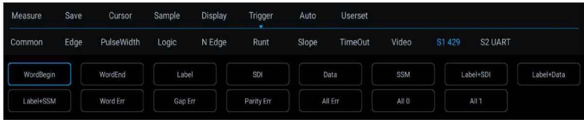
Рисунок 12-27. Меню конфигурации режима триггера шины ARINC429
