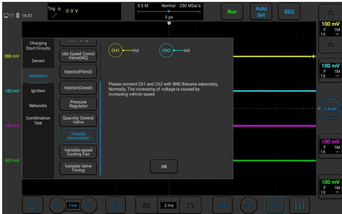
Рисунок 3-36. Проверка серводвигателя дроссельной заслонки
