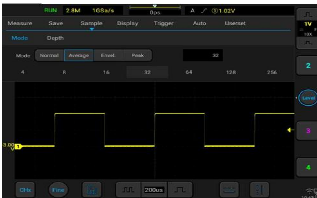
Рисунок 11-7. Осциллограмма после выбора среднего режима выборки со средним число 32
