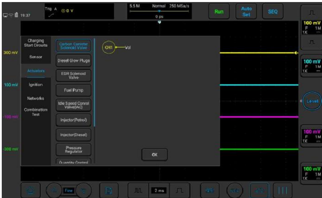
Рисунок 3-26. Проверка электромагнитного клапана угольного фильтра
