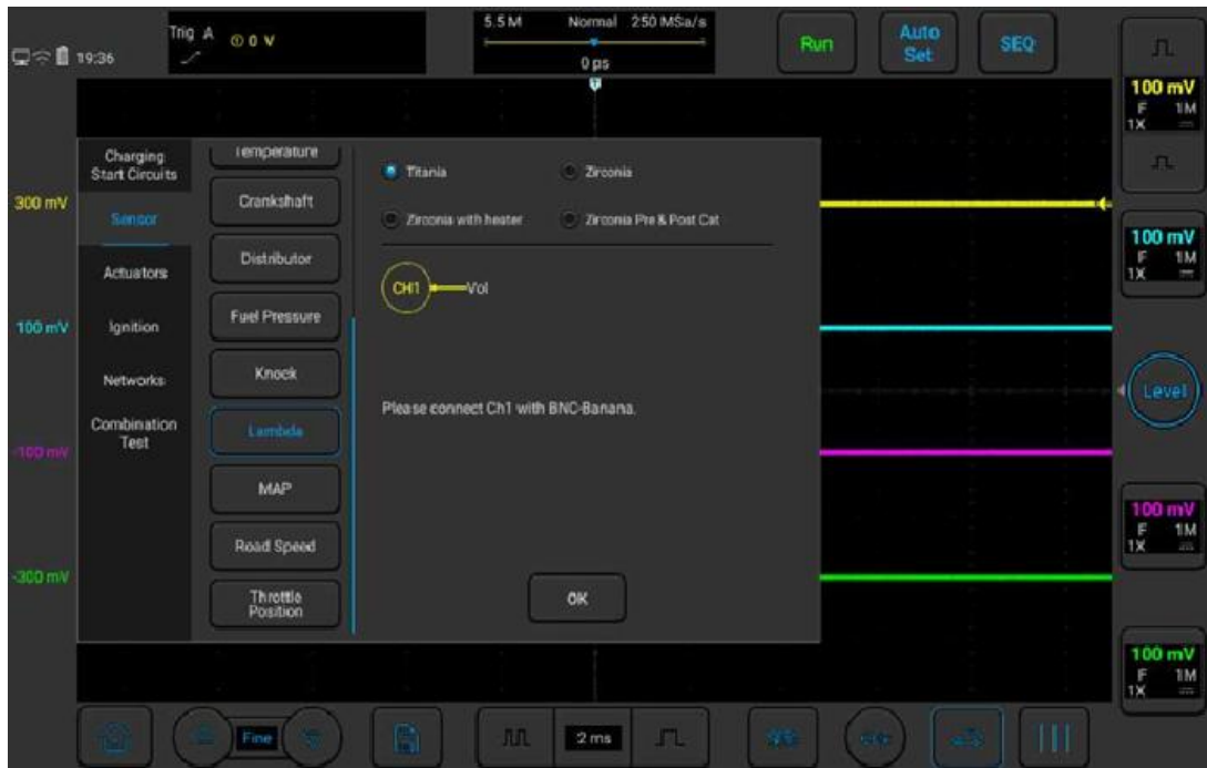
Рисунок 3-21. Испытание лямбда-зонда (датчика кислорода)
