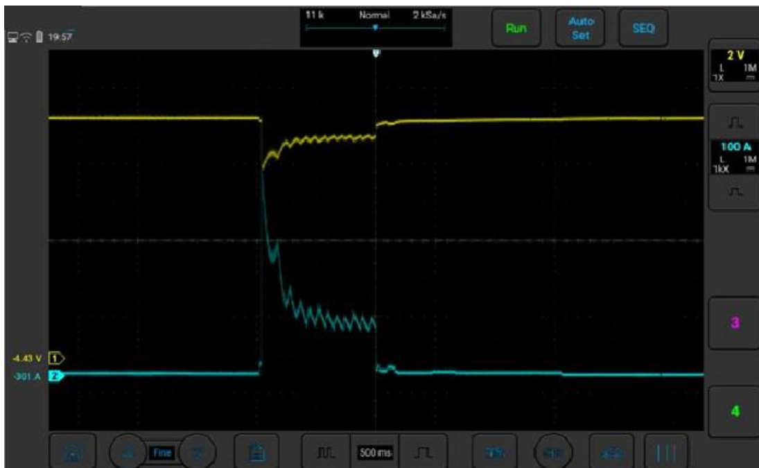
Рисунок 3-7. Пусковое напряжение и ток
