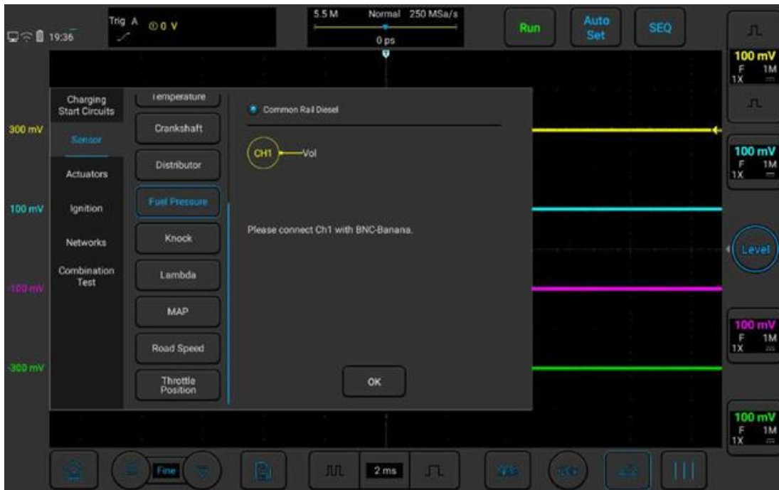
Рисунок 3-18. Испытание датчика давления топлива
