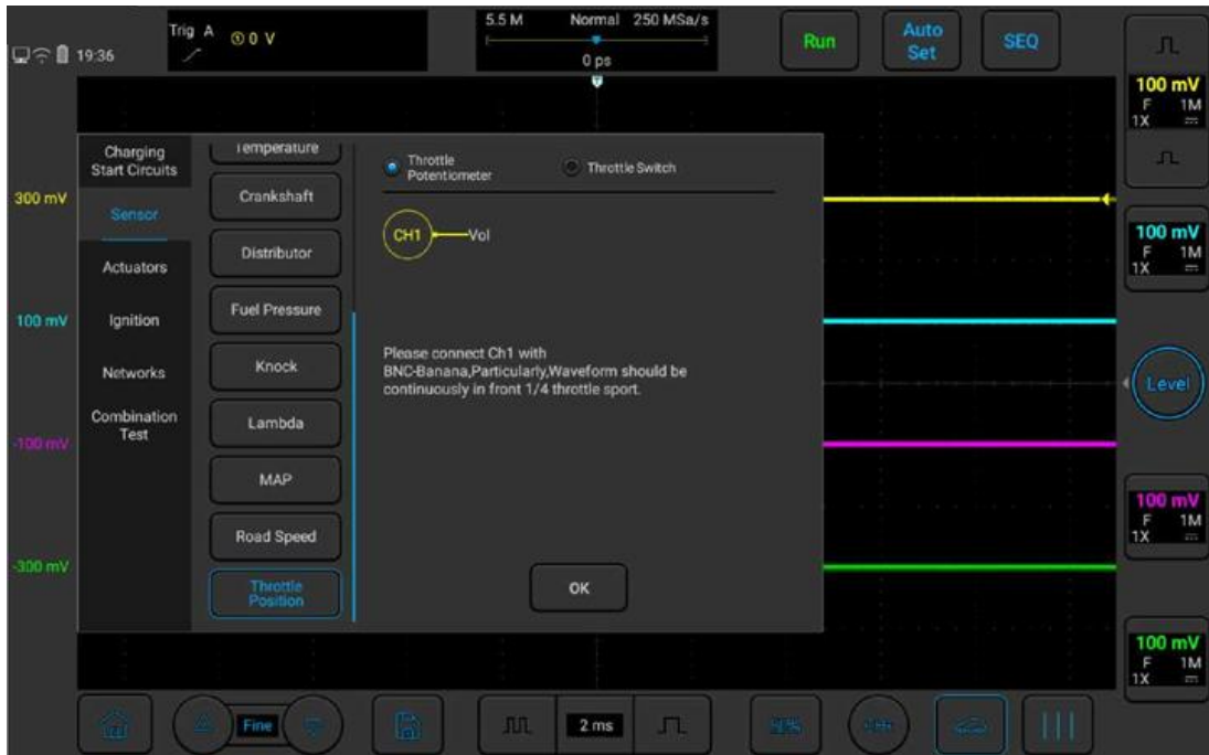
Рисунок 3-24. Испытание датчика положения дроссельной заслонки
