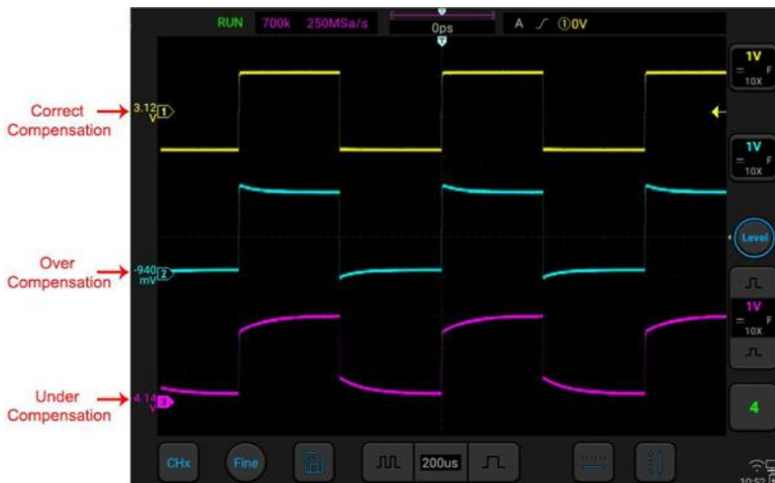
Рисунок 2-15. Компенсация пробника
