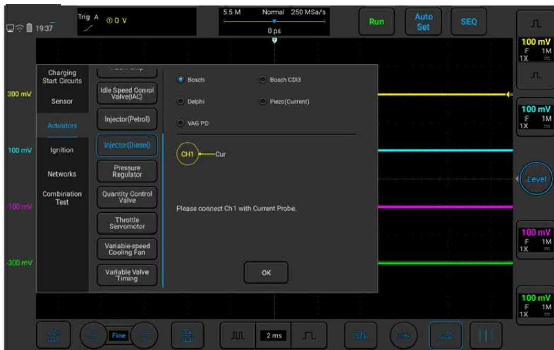
Рисунок 3-33. Проверка инжектора (дизельный двигатель)
