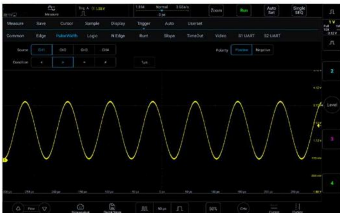
Рисунок 6-14. Меню настройки триггера по длительности импульса
