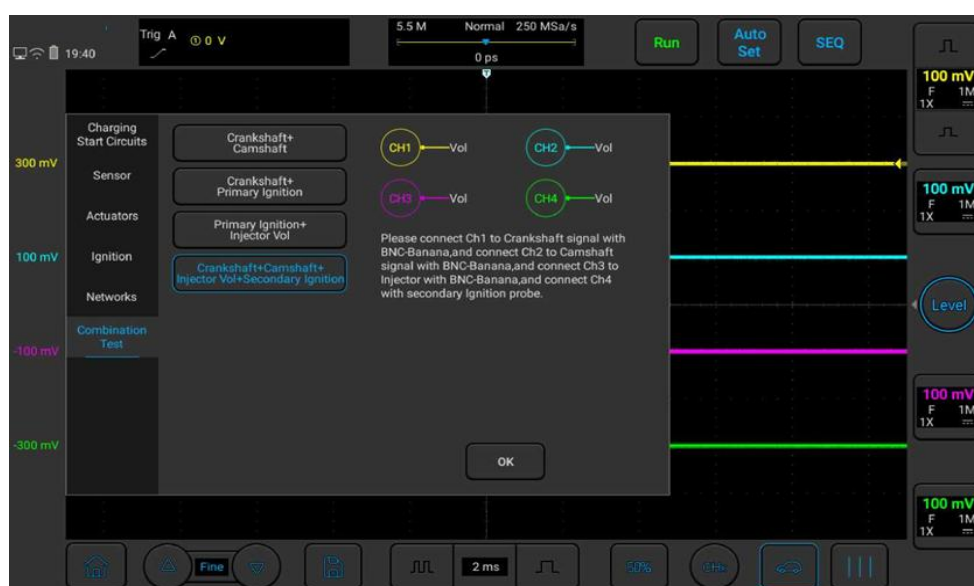
Рисунок 5-14. Комбинированное испытание коленчатого вала + распределительного вала + топливного инжектора + вторичной обмотки системы зажигания
