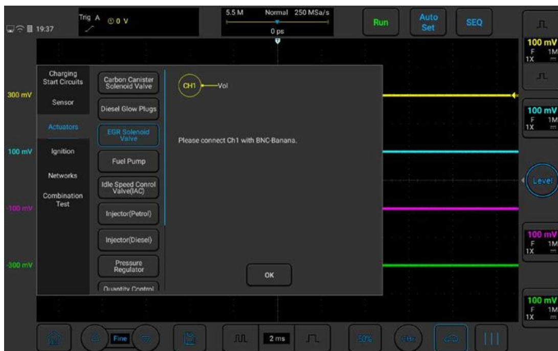
Рисунок 4-3. Проверка электромагнитного клапана рециркуляции отработавших газов
