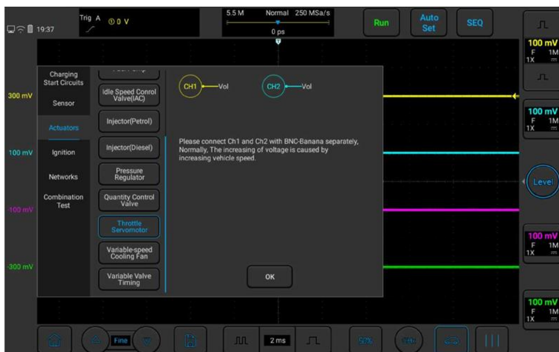
Рисунок 4-11. Проверка серводвигателя дроссельной заслонки
