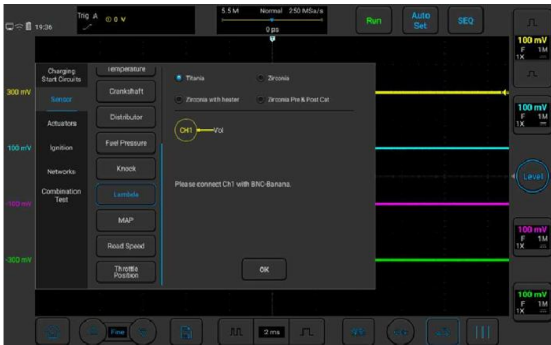
Рисунок 3-20. Испытание лямбда-зонда (датчика кислорода)
