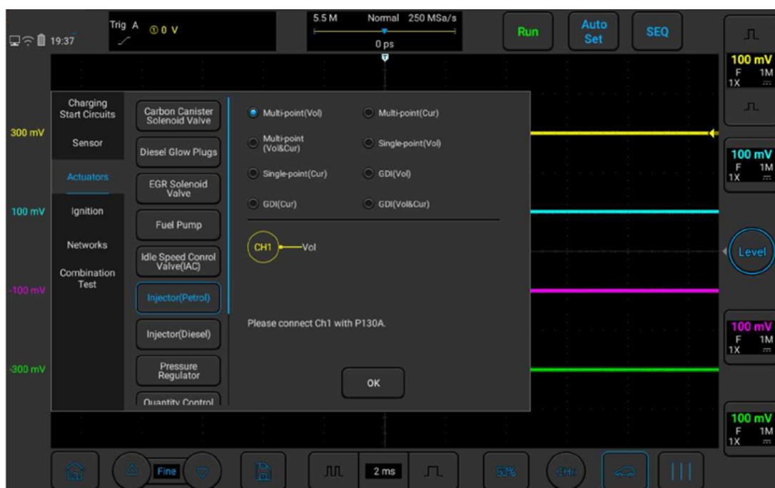
Рисунок 4-6. Проверка инжектора (бензин)
