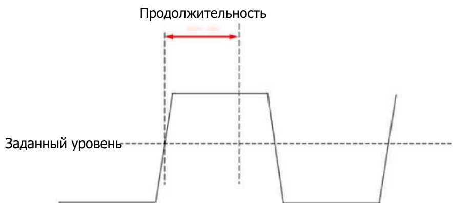
Рисунок 7-28. Схема триггера по лимиту времени
