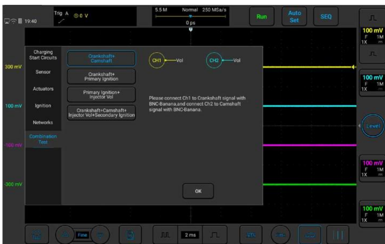
Рисунок 5-11. Комбинированное испытание коленчатого вала и распределительного вала
