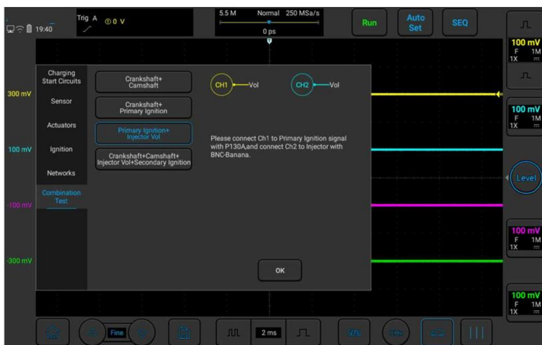
Рисунок 5-13. Первичная обмотка системы зажигания + напряжение инжектора
