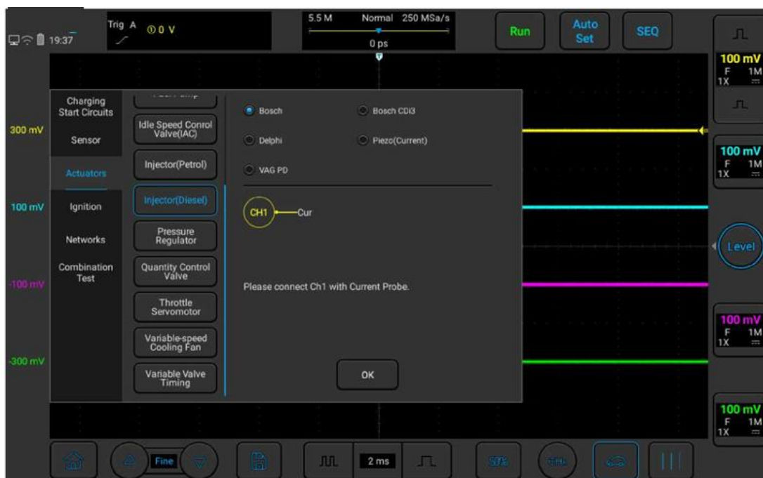
Рисунок 4-8. Проверка инжектора (дизельный двигатель)
