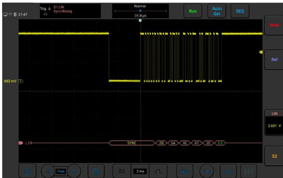
Рисунок 5-8. Измерение LIN-шины автомобиля Audi A6
