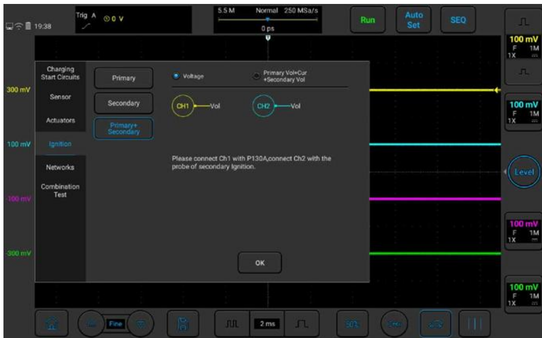
Рисунок 5-4. Испытание первичной + вторичной обмотки системы зажигания
