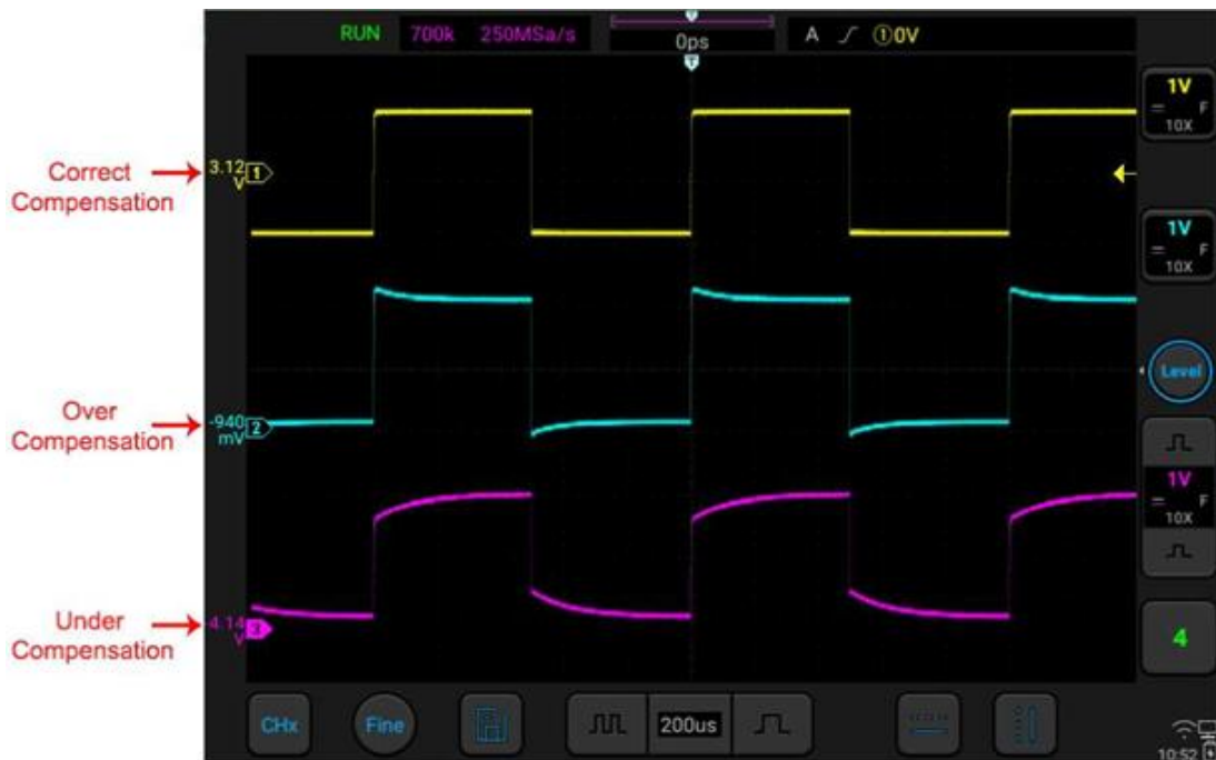
Рисунок 2-14. Компенсация пробника
