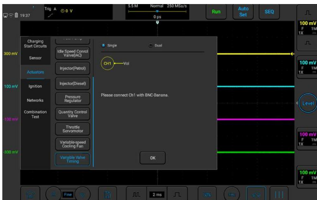
Рисунок 4-13. Проверка изменения фаз газораспределения
