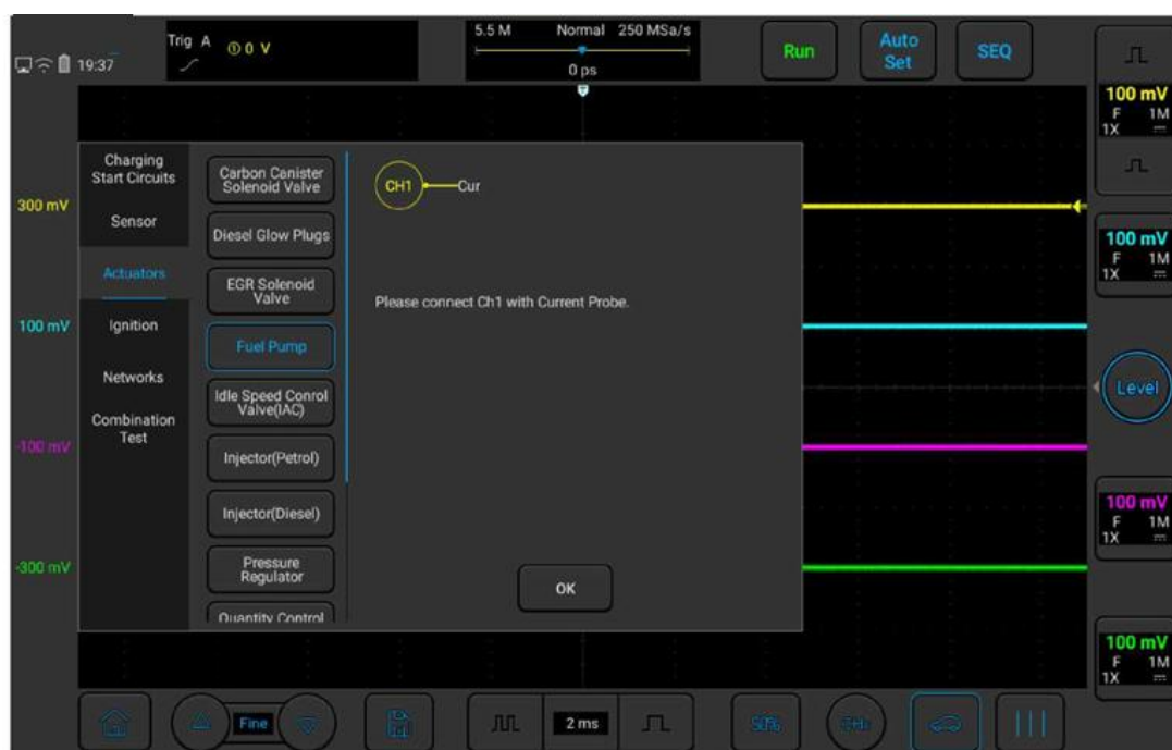
Рисунок 4-4. Проверка электронного топливного насоса
