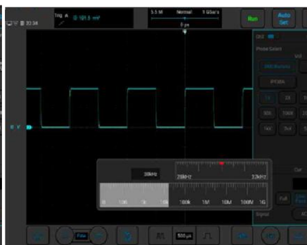
Рисунок 5-37. Фильтр низких частот
