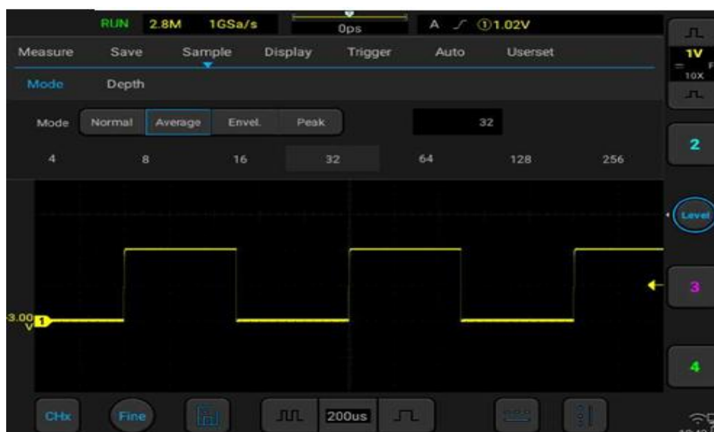
Рисунок 11-7. Осциллограмма после выбора среднего режима выборки со средним числом 32
