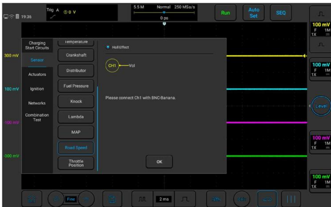
Рисунок 3-23. Испытание датчика скорости автомобиля
