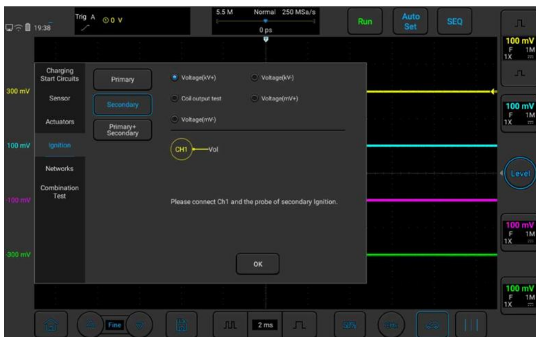
Рисунок 5-3. Испытание вторичной обмотки системы зажигания
