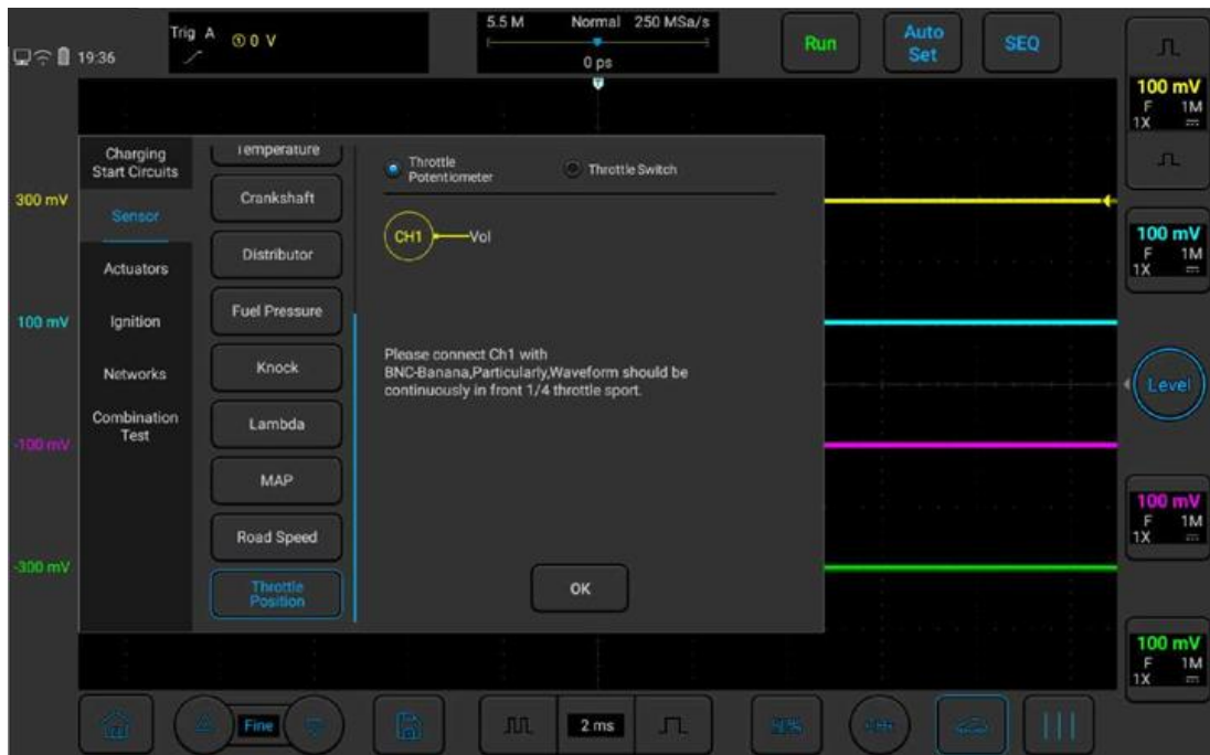
Рисунок 3-24. Испытание датчика положения дроссельной заслонки
