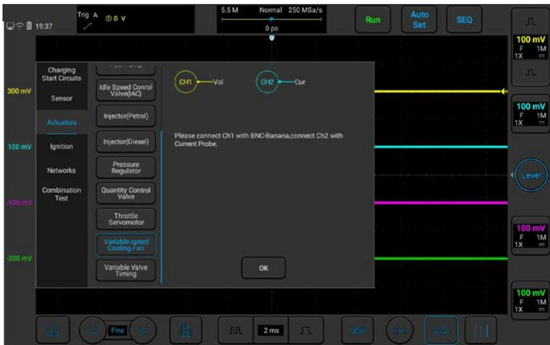
Рисунок 4-12. Проверка вентилятора охлаждения с переменной скоростью
