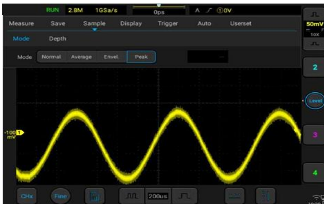
Рисунок 11-6. Синусоида с неровностями. Пиковый режим выборки
