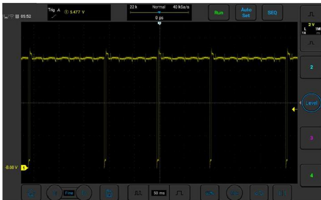
Рисунок 4-2. Сигнал электромагнитного клапана бачка с активированным углем Audi A6
