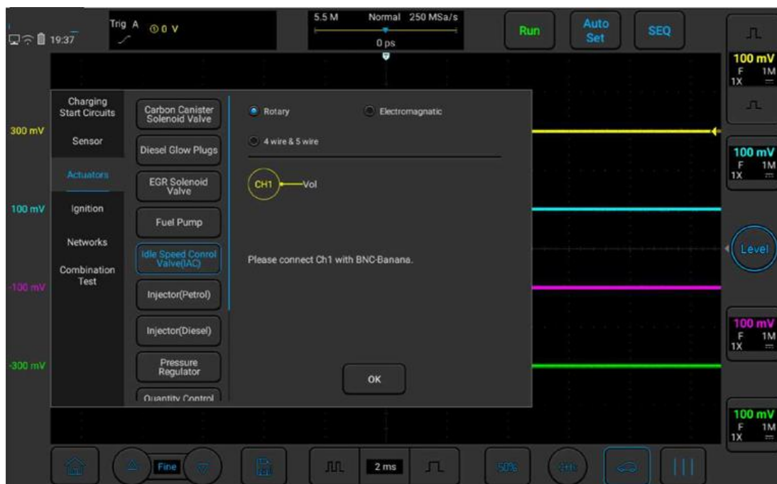
Рисунок 4-5. Проверка клапана регулировки холостого хода
