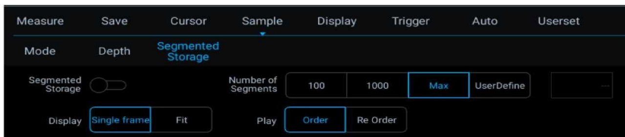
Рисунок 10-10. Настройки сегментированного хранилища
