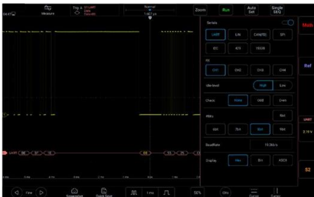
Рисунок 11-1. Меню выбора типа шины
