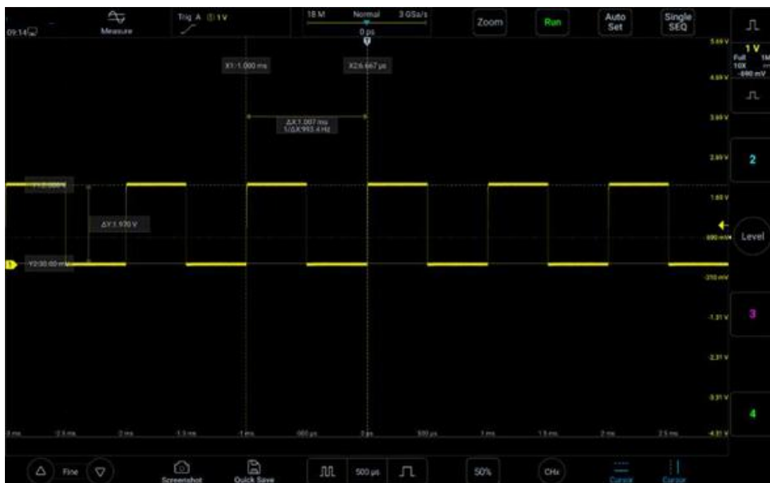
Рисунок 6-16. Описание измерения курсором
