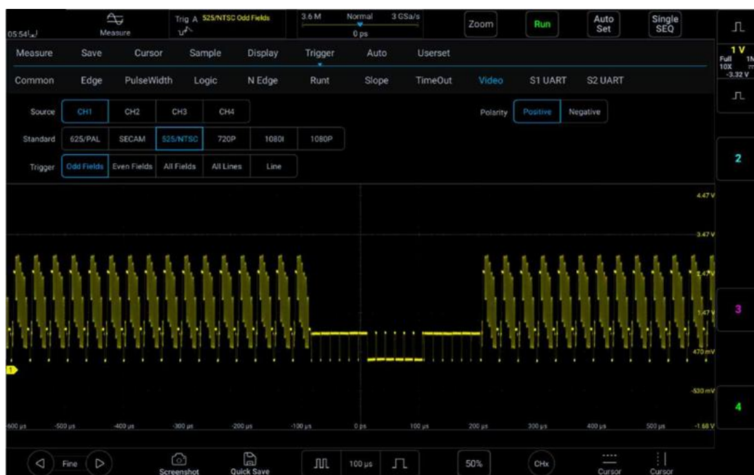
Рисунок 5-30. Триггер по видеосигналу
