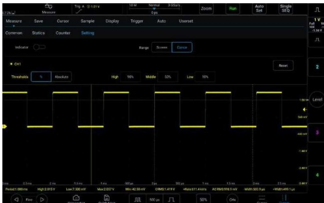
Рисунок 6-9. Автоматический выбор диапазона измерений курсором
