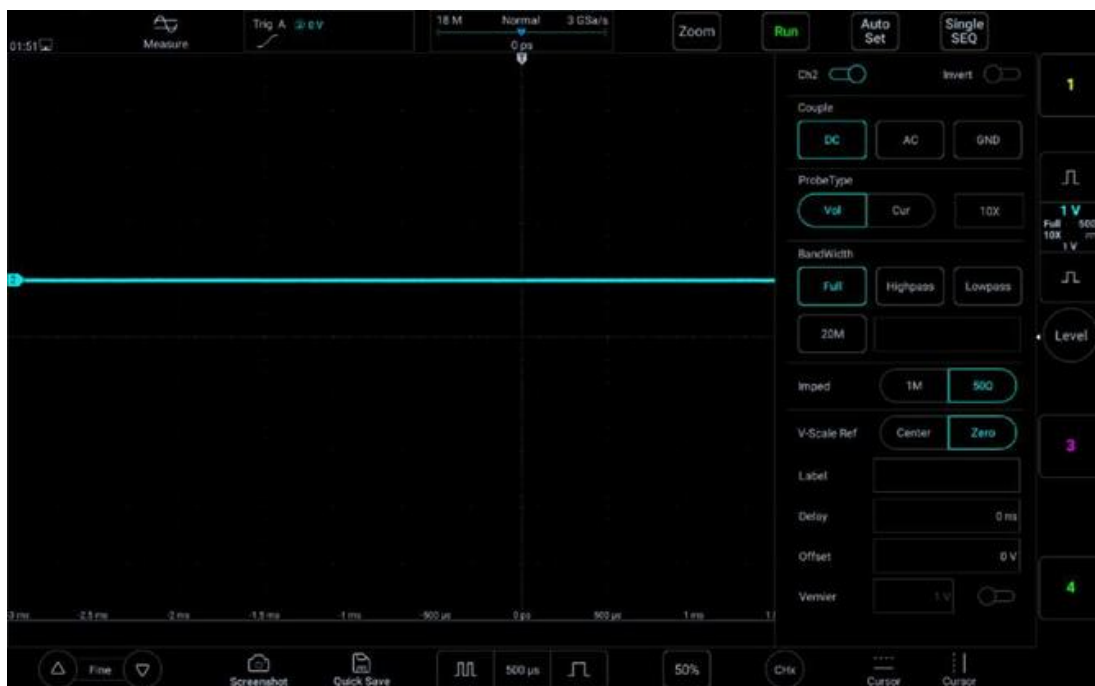
Рисунок 4-17. Входное полное сопротивление канала
