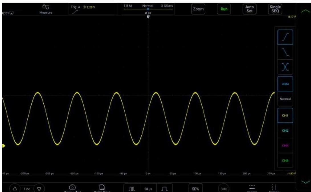
Рисунок 5-9. Ярлыки настройки триггера
