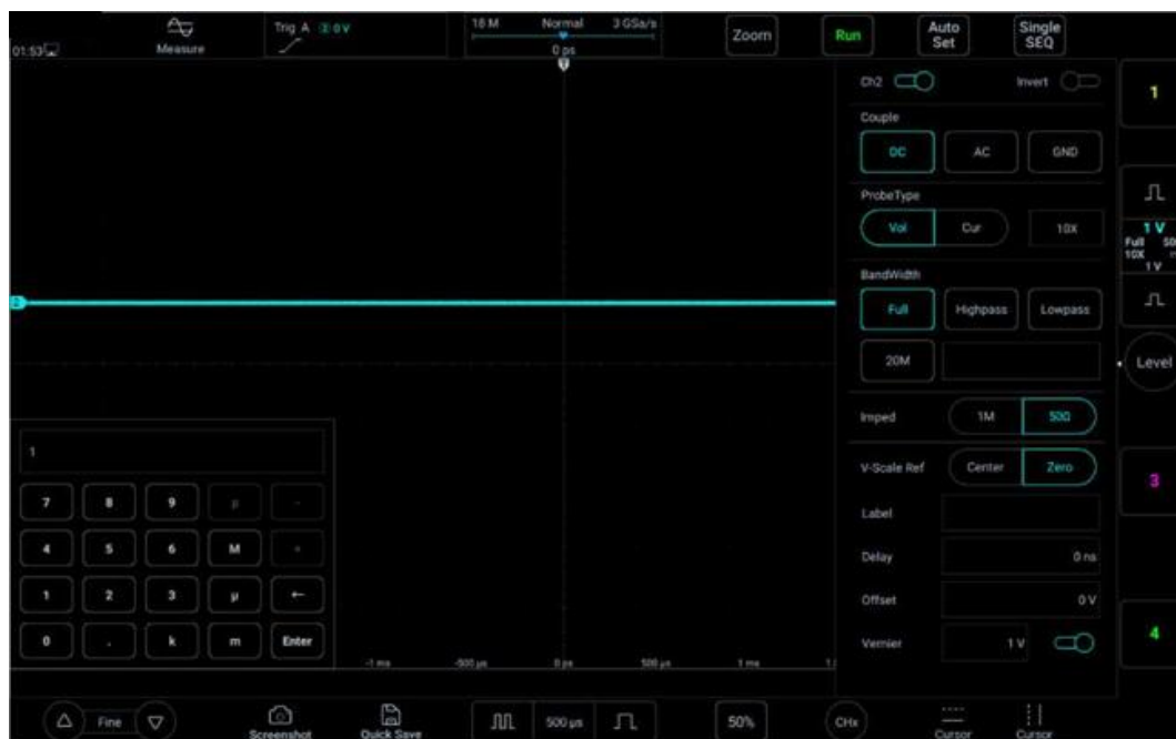
Рисунок 4-18. Настройка точной шкалы
