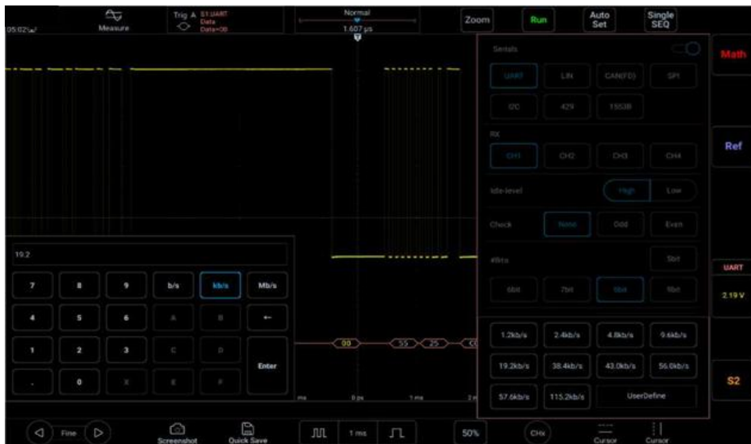
Рисунок 11-5. Настройка скорости передачи данных по умолчанию
