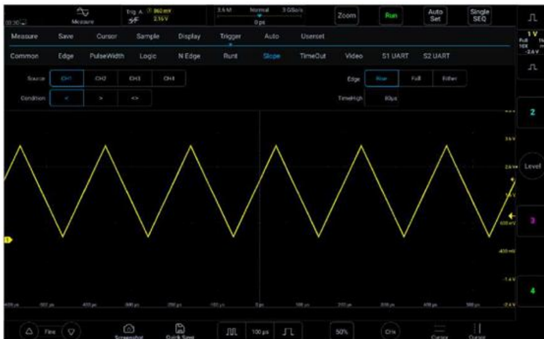
Рисунок 5-27. Меню настройки триггера по наклону
