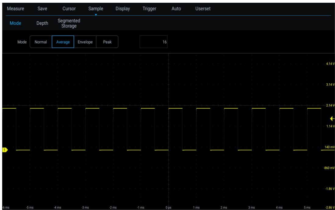
Рисунок 10-7. Осциллограмма после выбора среднего режима выборки со средним числом 16
