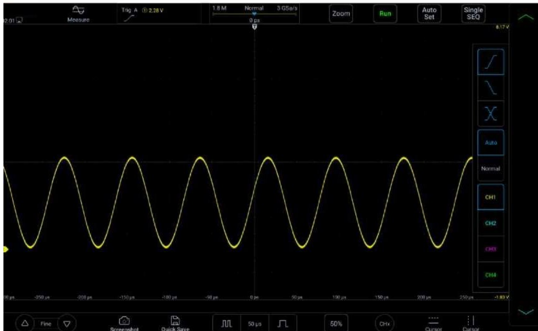
Рисунок 5-9. Ярлыки настройки триггера
