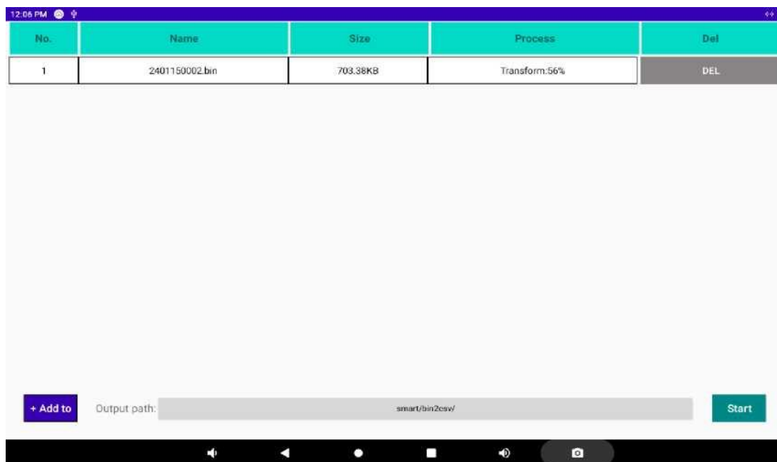
13-17. Выполняется преобразование BIN в CSV
