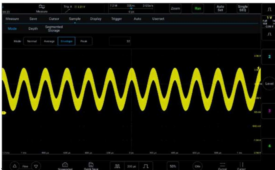
Рисунок 10-8. Сигнал в огибающем режиме выборки (32)
