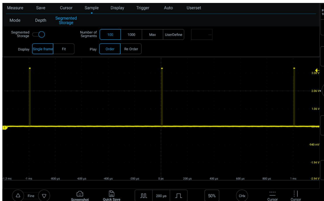
Рисунок 10-11. Получение осциллограмм из сегментированного хранилища
