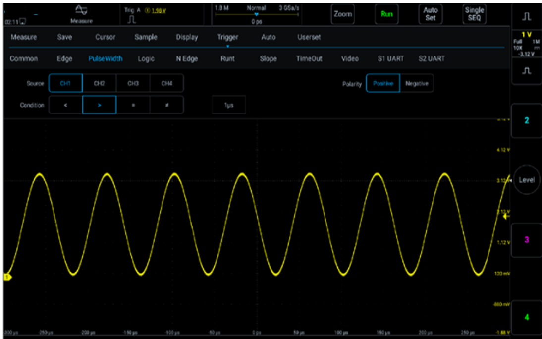
Рисунок 5-15. Изменение уровня импульса отрицательной полярности
