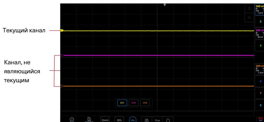
Рисунок 5-2. Текущий канал и канал, не являющийся текущим
