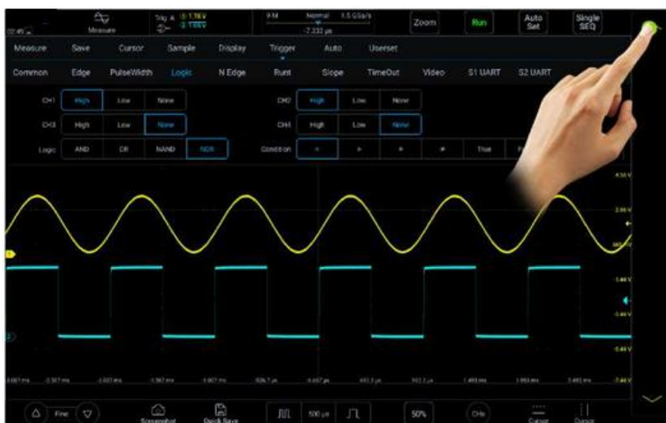
Рисунок 6-22. Регулировка уровня триггера
