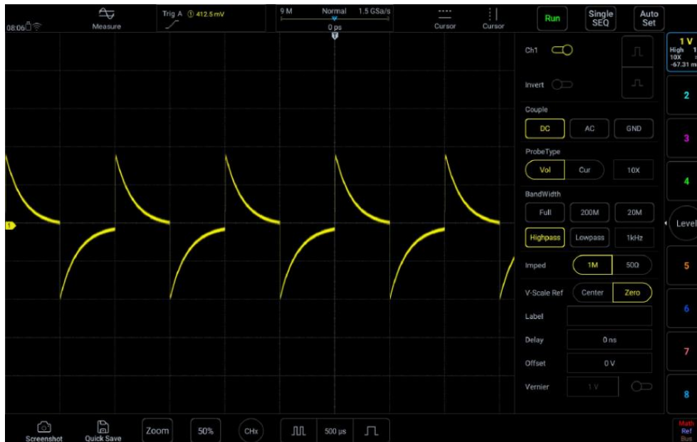
Рисунок 5-13. Фильтр верхних частот
