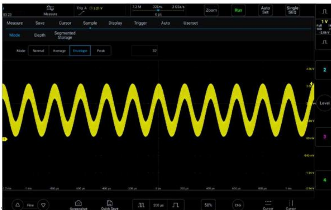
Рисунок 11-8. Сигнал в огибающем режиме выборки (32)
