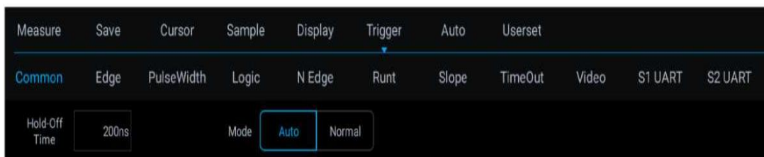
Рисунок 6-5. Настройка режима триггера осциллографа
