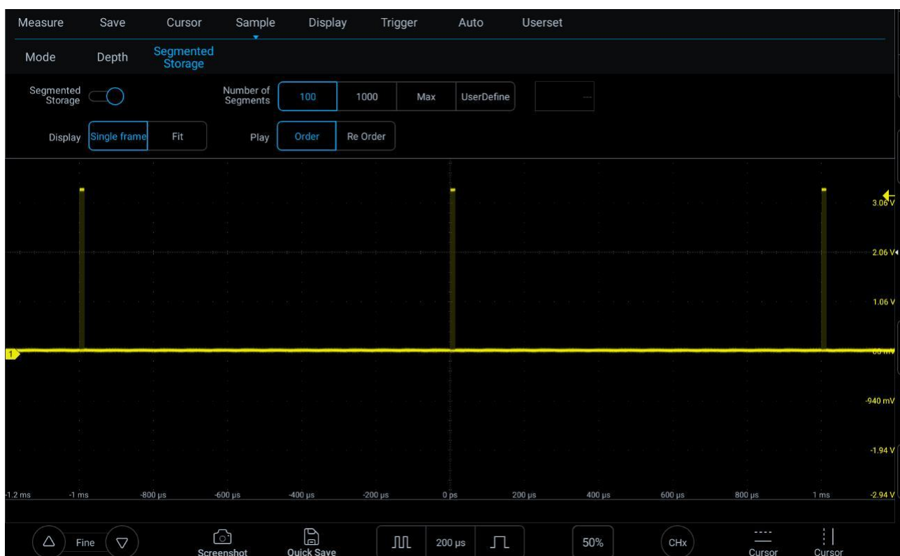
Рисунок 11-11. Получение осциллограмм из сегментированного хранилища
