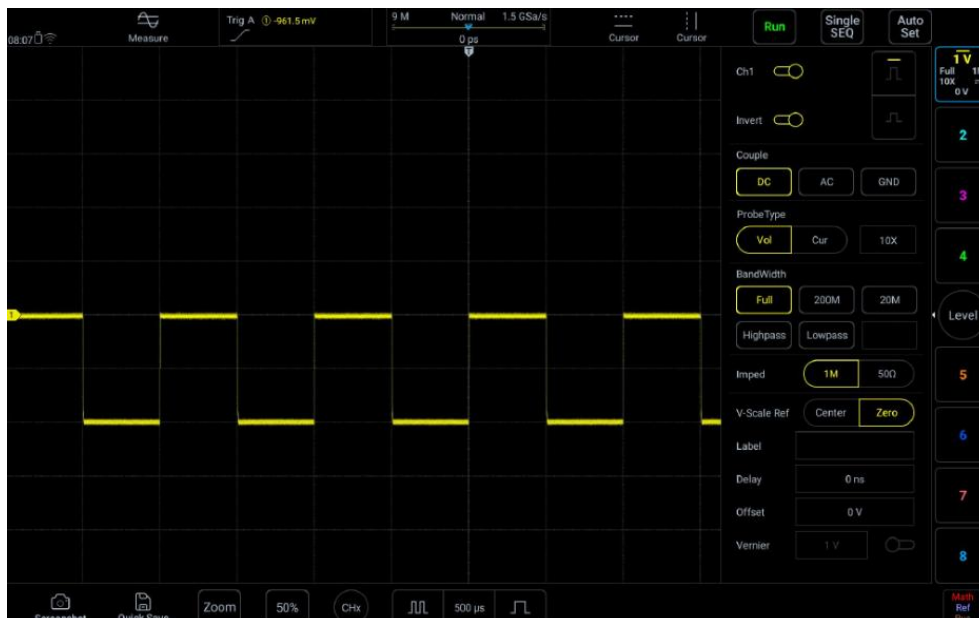
Рисунок 5-16. После инверсии с учетом формы импульса
