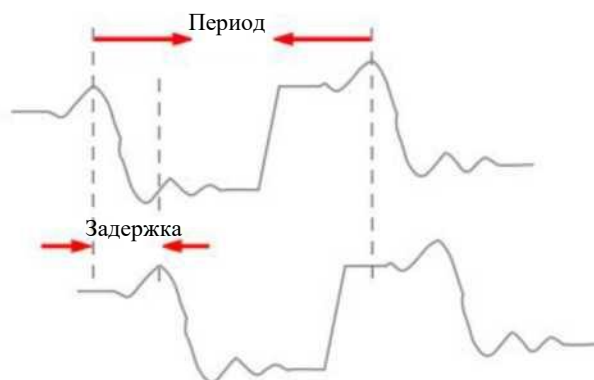
Рисунок 7-6. Схема измерения фазы
