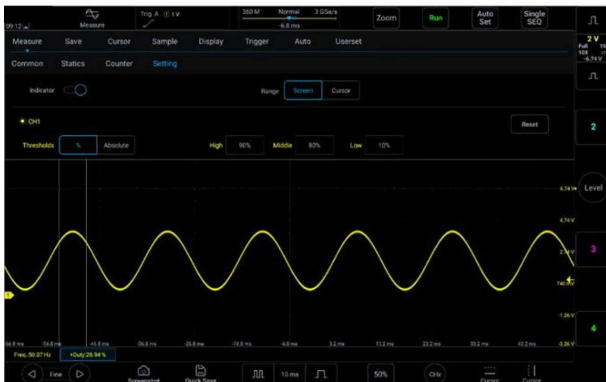
Рисунок 7-13. Длительность импульса при установке среднего порогового значения на 80%
