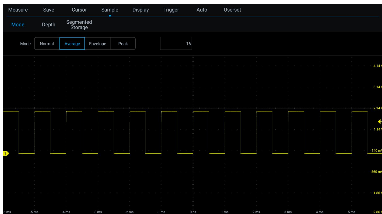
Рисунок 11-7. Осциллограмма после выбора среднего режима выборки со средним числом 16
