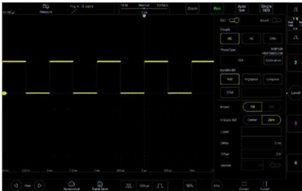
Рисунок 5-7.Связь по постоянному току
