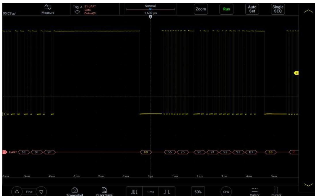
Рисунок 11-7. Регулировка уровня декодирования шины UART
