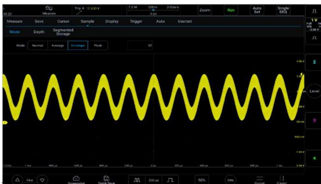
Рисунок 10-8. Сигнал в огибающем режиме выборки (32)
