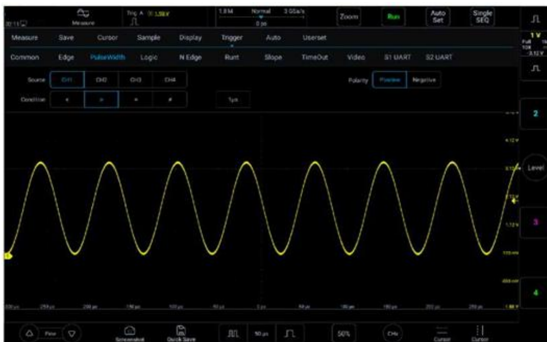
Рисунок 5-14. Меню настройки триггера по длительности импульса
