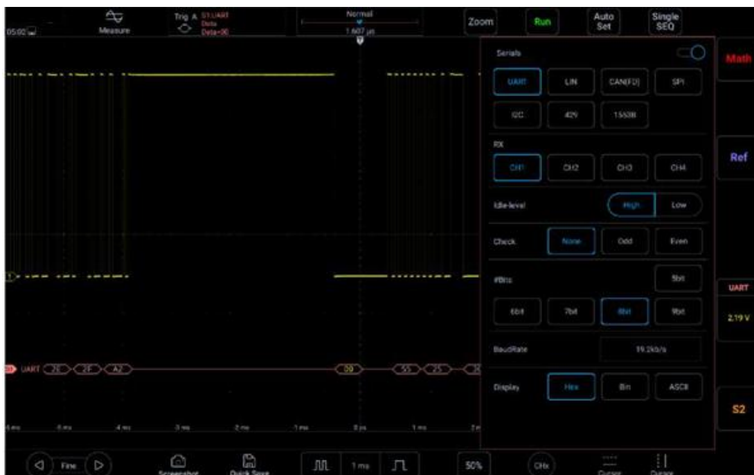
Рисунок 11-4. Меню конфигурации шины UART
