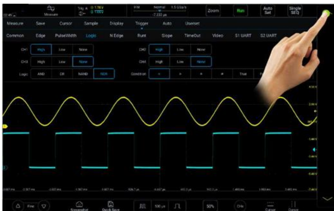
Рисунок 5-22. Регулировка уровня триггера
