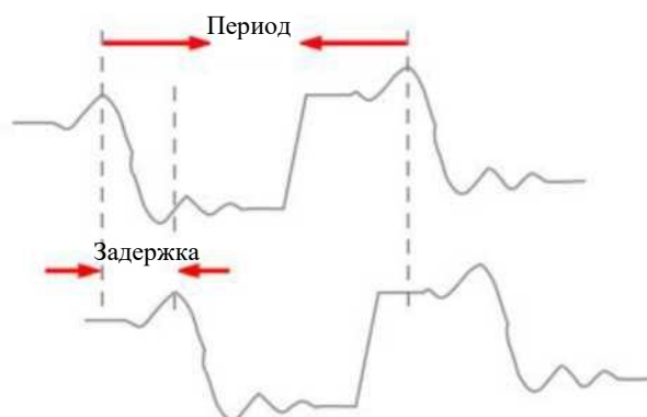
Рисунок 6-6. Схема измерения фазы
