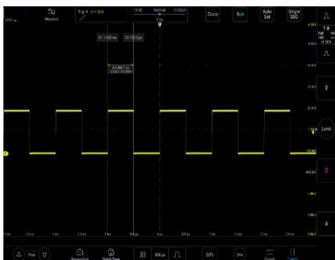
Рисунок 6-18. Длительность импульса при измерении курсором
