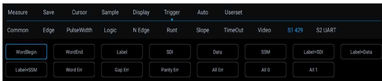
Рисунок 11-27. Меню конфигурации режима триггера шины ARINC429
