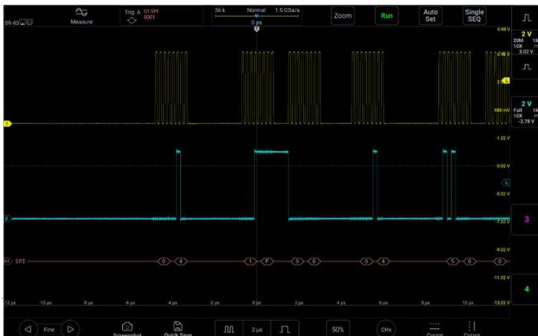
Рисунок 11-20. Интерфейс декодирования шины SPI
