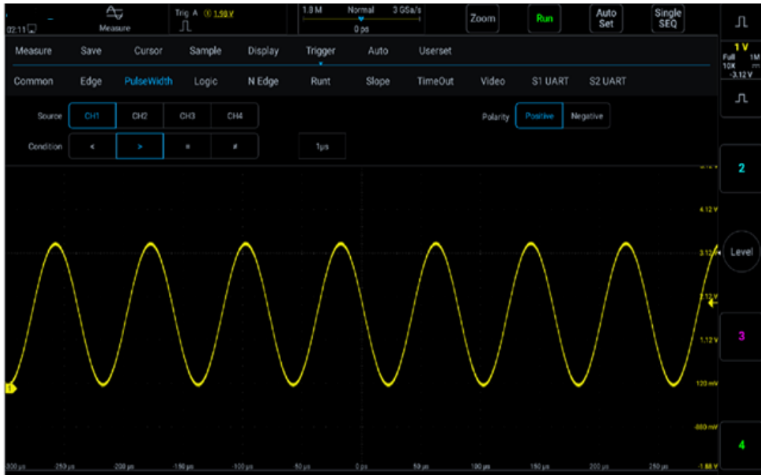
Рисунок 5-15. Изменение уровня импульса отрицательной полярности
