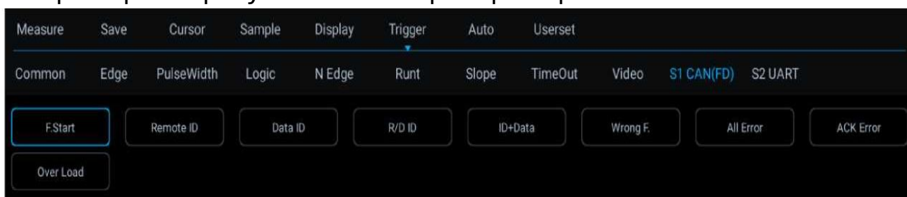
Рисунок 11-15. Меню конфигурации режима триггера шины CAN FD
