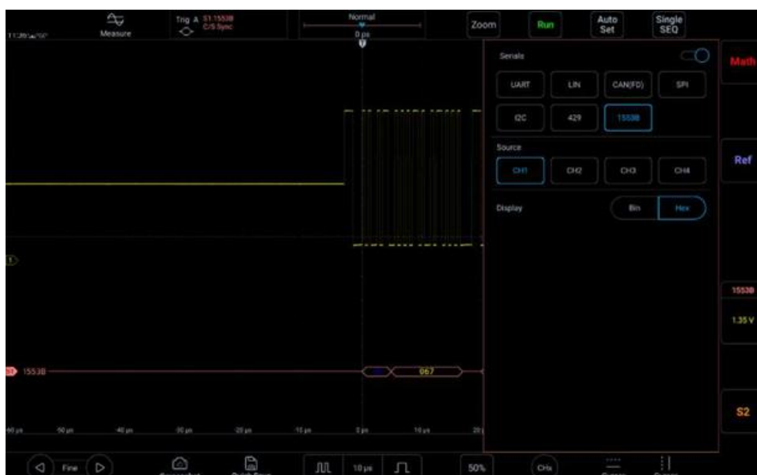
Рисунок 11-30. Меню конфигурации шины 1553B
