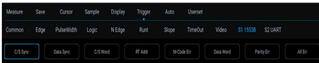
Рисунок 11-31. Меню конфигурации режима триггера шины 1553В
