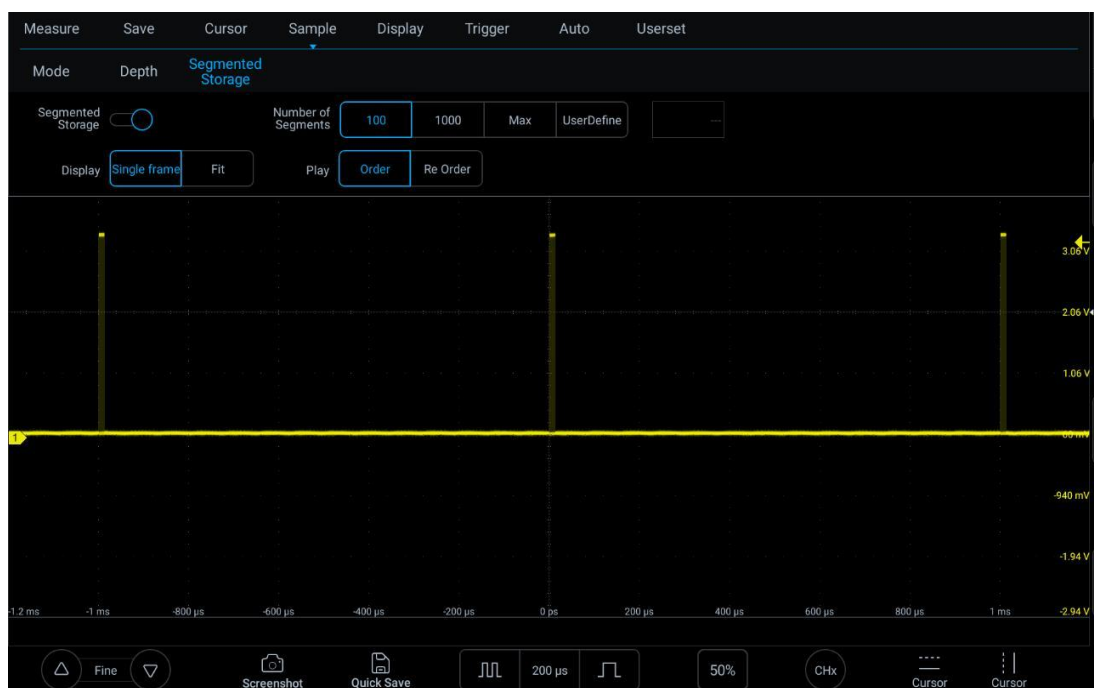
Рисунок 10-11. Получение осциллограмм из сегментированного хранилища
