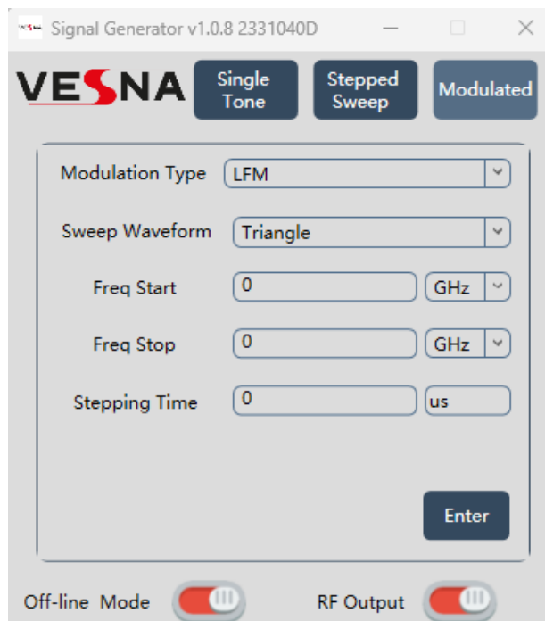
Рисунок 7-3. Интерфейс настройки ЛЧМ модуляции
