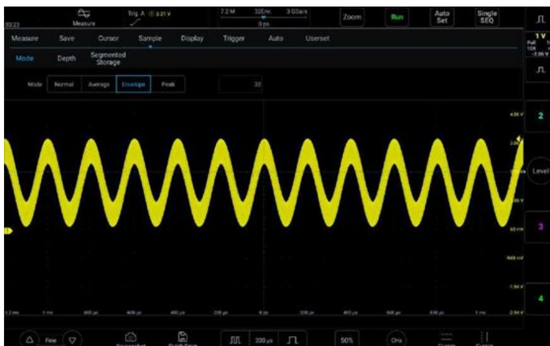
Рисунок 10-8. Сигнал амплитудной модуляции в режиме выборки «Огибающая» (32)
