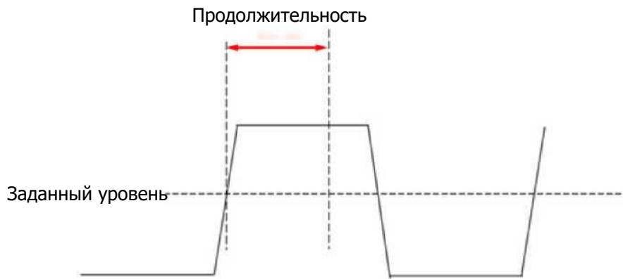
Рисунок 5-28. Схема триггера по лимиту времени
