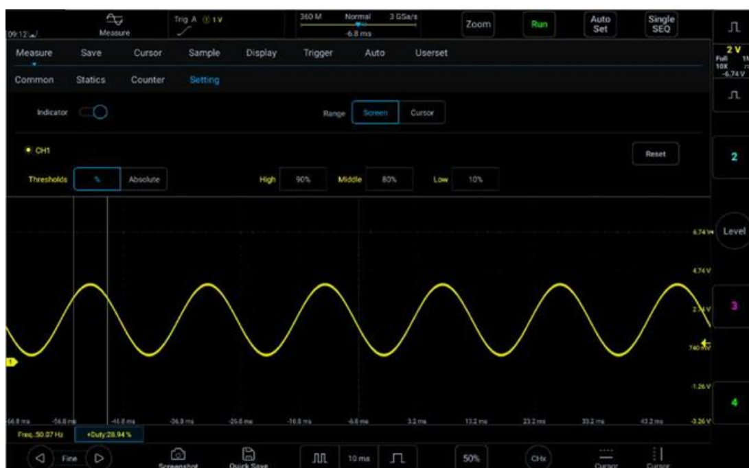
Рисунок 6-13. Длительность импульса при установке среднего порогового значения на 80%
