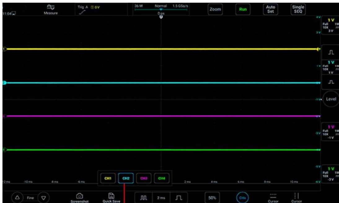
Рисунок 4-4. Открытие, закрытие и переключение каналов
