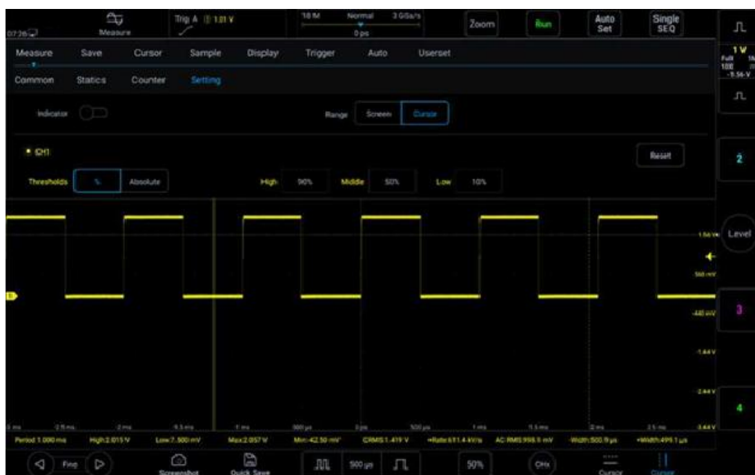
Рисунок 6-9. Автоматический выбор диапазона измерений курсором
