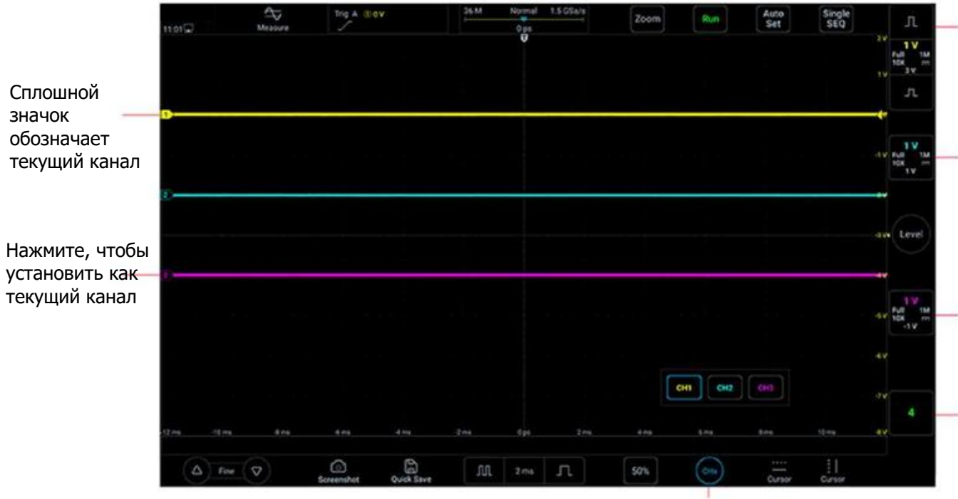
Рисунок 4-4. Открытие, закрытие и переключение каналов
