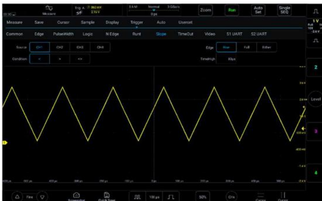
Рисунок 6-27. Меню настройки триггера по наклону
