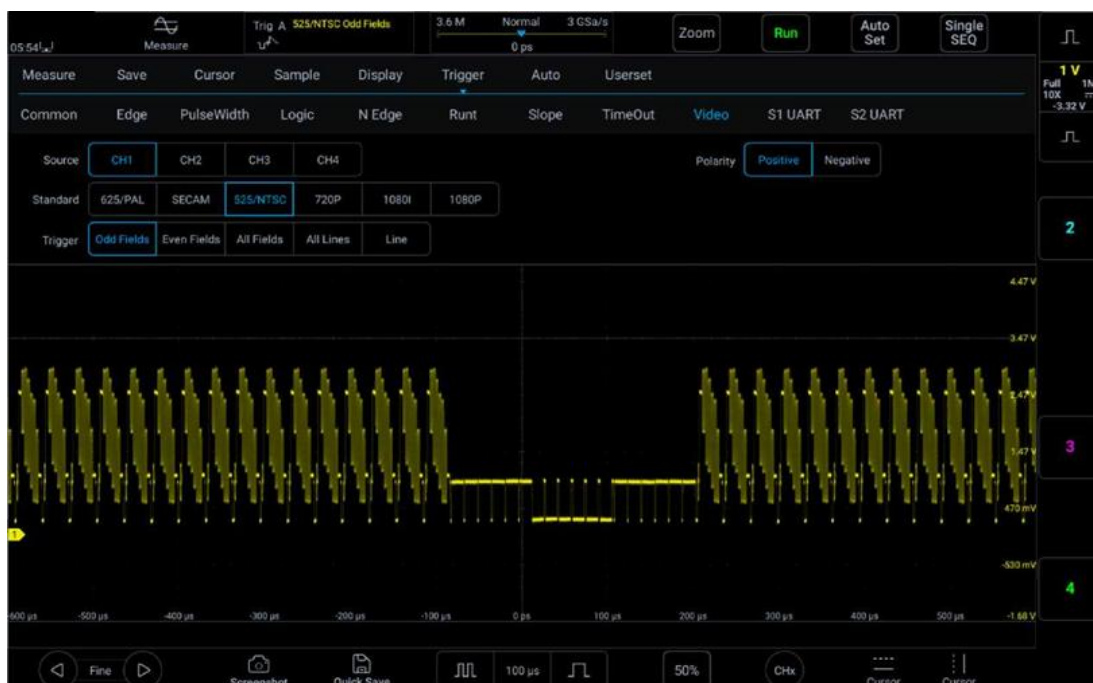
Рисунок 6-30. Триггер по видеосигналу
