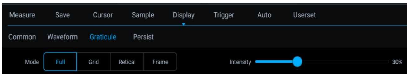
Рисунок 9-3. Меню отображения сетки
