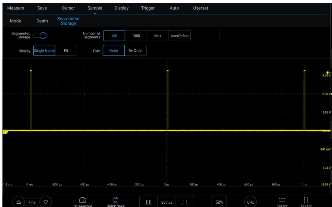
Рисунок 10-12. Получение осциллограмм из сегментированного хранилища
