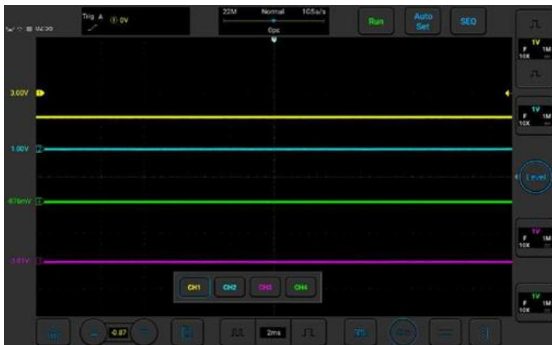
Рисунок 2-13. Ручная калибровка нулевого значения
