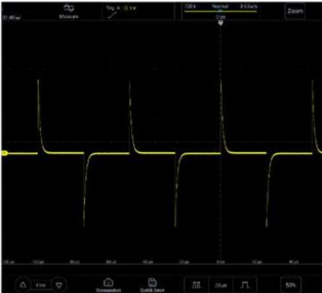
Рисунок 4-12. Фильтр верхних частот
