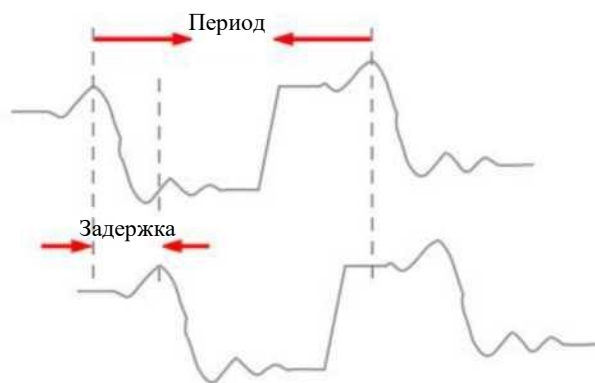
Рисунок 6-6. Схема измерения фазы
