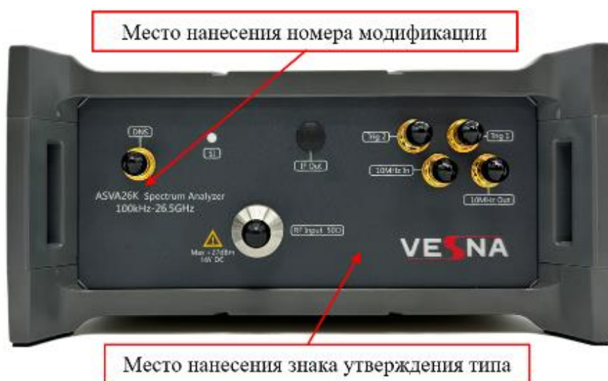
Рисунок 2 – Общий вид анализаторов спектра VESNA ASVA с указанием места нанесения номера модификации VESNA ASVA26K и знака утверждения типа
