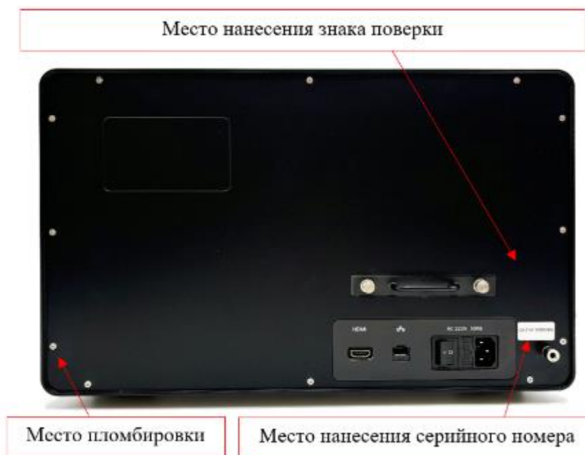
Рисунок 3 – Вид задней панели модификации VESNA ASVA26 с указанием места пломбировки, мест нанесения серийного номера и знака поверки
