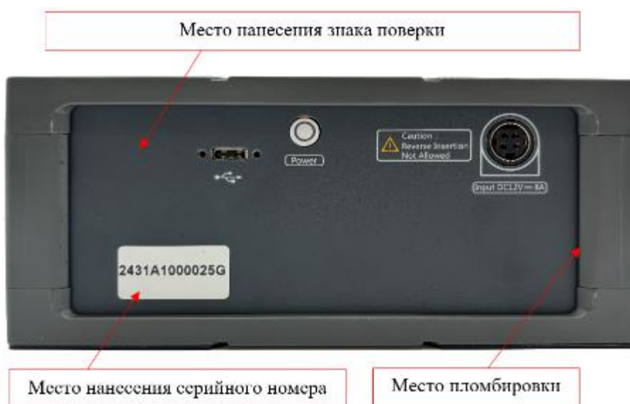
Рисунок 4 – Вид задней панели модификации VESNA ASVA26K с указанием места пломбировки, мест нанесения серийного номера и знака поверки
